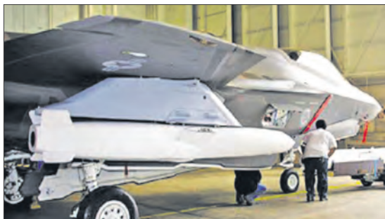
Управляемая ракета JSM на тактическом истребителе F-35A «Лайтнинг-2»: на внешней подвеске (слева) и в отсеке вооружения (справа)
