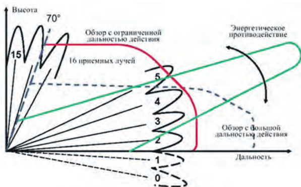
Диаграммы направленности антенны РЛС SMART-L в вертикальной плоскости для различных режимов излучения
