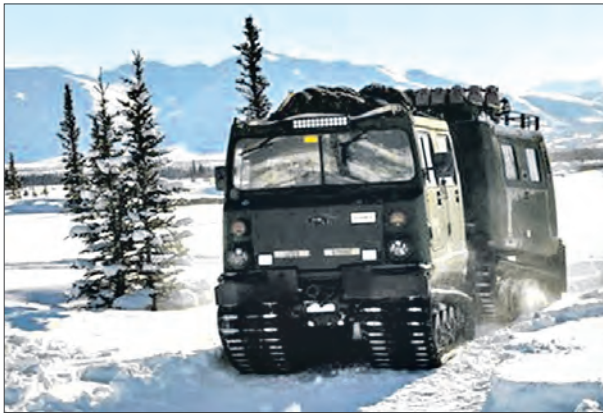
Транспортная машина серии Bv206 производства Швеции начала 1980-х годов. Такие средства планируется заменить новыми BvS10 «Беовульф»
