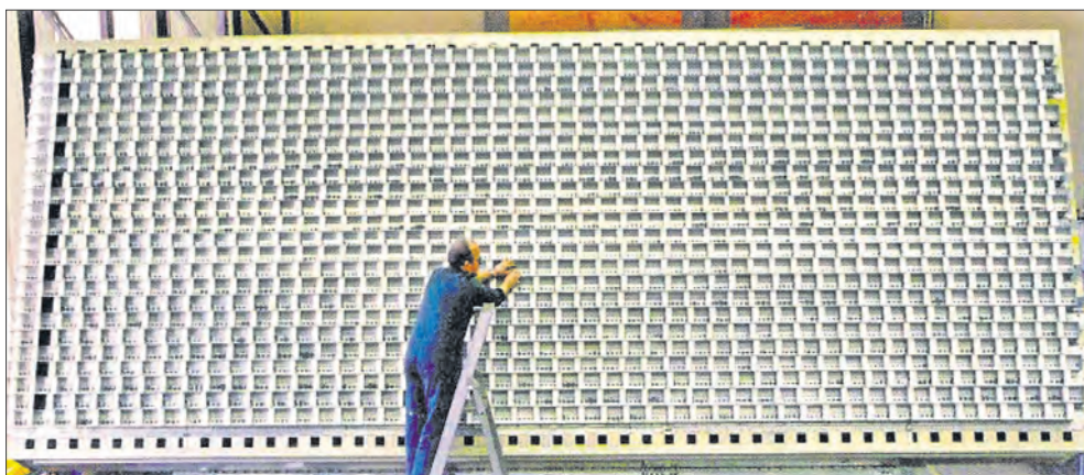
Фазированная антенная решетка РЛС SMART-L на сборочном стенде
