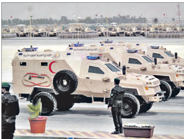
В вооруженных силах Саудовской Аравии имеется техника грузинского производства – БМ «Дидгори-2» в варианте медико-эвакуационной машины, поставленные в страну в 2016 году
