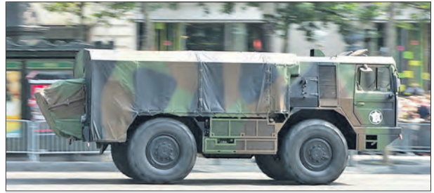
Тактический автомобиль «Матени» (колесная формула 4 x 4), на котором устанавливается система минного заградителя
