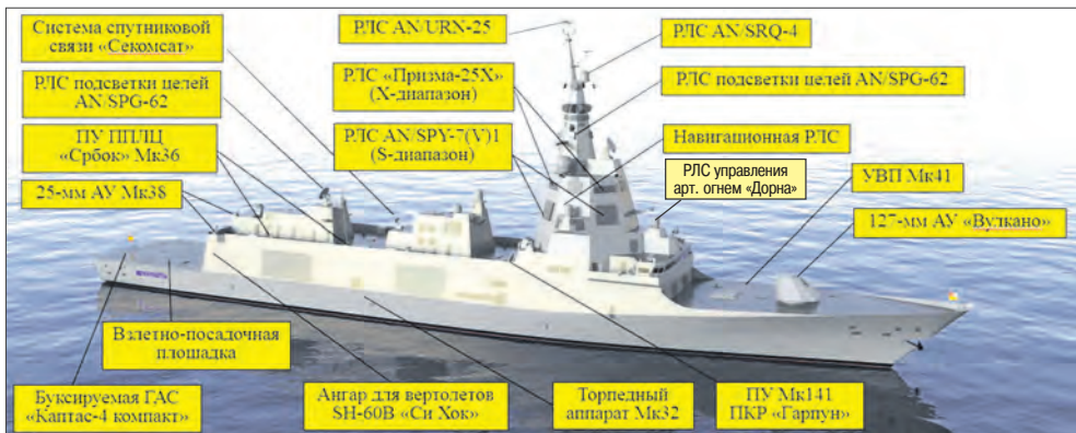
Схема размещения вооружения и радиоэлектронных средств на борту фрегата УРО типа «Бонифас»
