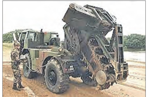
Минный заградитель модель F2 EMP (вверху – подающий механизм; внизу – машина в боевом положении)
