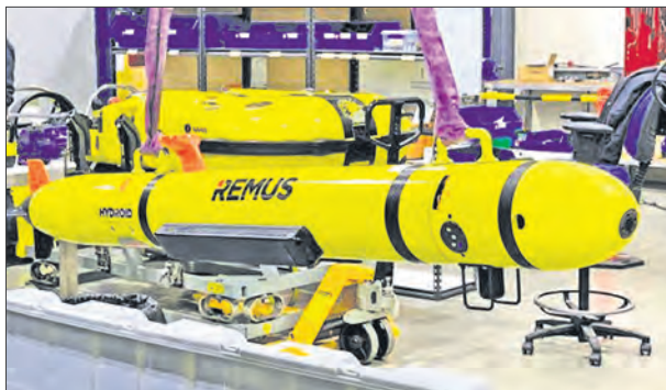
Малый автономный необитаемый подводный аппарат типа «РЕМУС-300»
