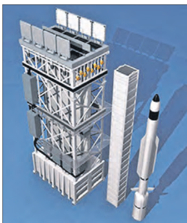
Слева направо: пусковая установка Mk141, установка вертикального пуска Mk41 с ЗУР RIM-67 «Стандарт-2» и ЗУР RIM-162B «Усов. Си Спарроу»
