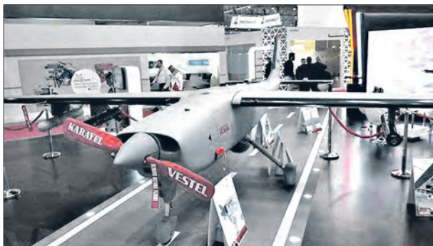
Ударный беспилотный летательный аппарат «Караел-СУ» турецкой компании «Вестел дифенс» способен нести до 120 кг полезной нагрузки, в том числе управляемые бомбы
