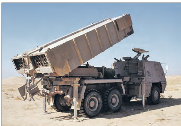
На вооружении артиллерийских подразделений имеются самоходные реактивные системы залпового огня «Астрос-2» бразильского производства с дальностью стрельбы до 60 км
