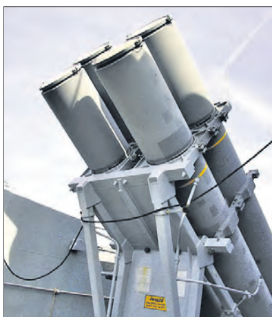
Слева направо: пусковая установка Mk141, установка вертикального пуска Mk41 с ЗУР RIM-67 «Стандарт-2» и ЗУР RIM-162B «Усов. Си Спарроу»
