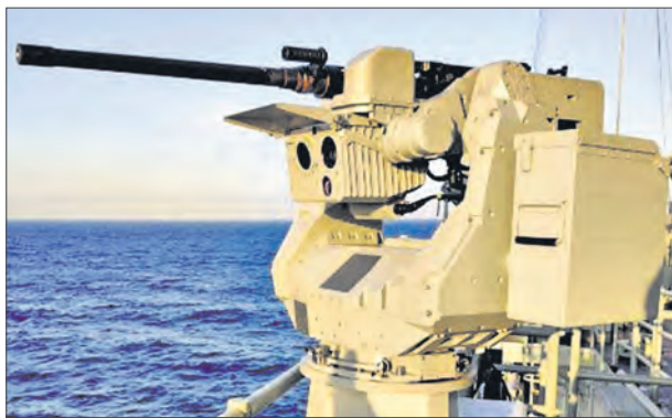
Дистанционно управляемый модуль вооружения «Сентинел» с 12,7-мм пулеметом
