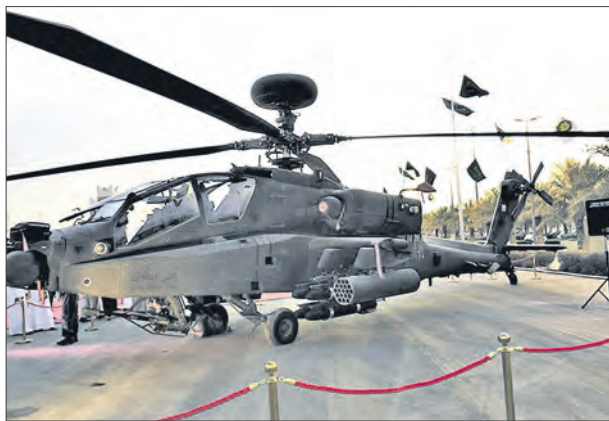
Ударный вертолет AH-64D «Апач Лонгбоу» с противотанковыми ракетами «Хеллфайр»
