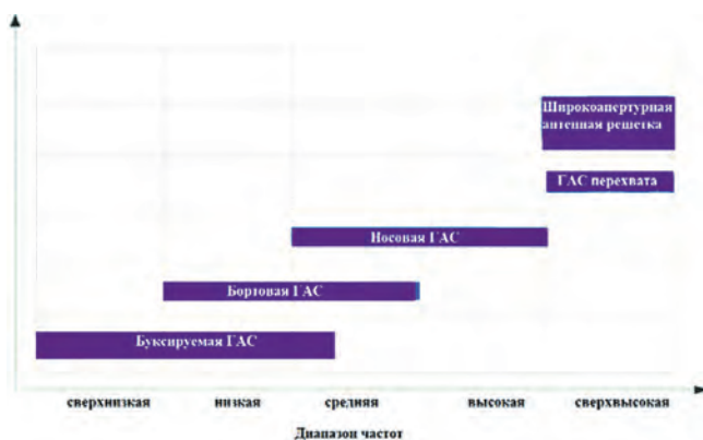
Примерные области рабочих частот различных гидроакустических станций
