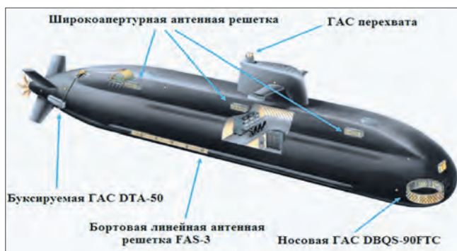
Размещение антенн гидроакустических станций на подводной лодке проект 212А
