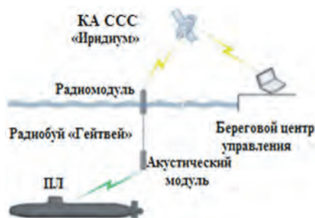
Буй-шлюз «Гейтвей» в сборе и схема его работы
