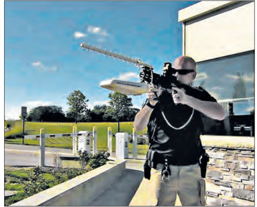
Средство радиоэлектронной борьбы «Бэттл дрон дефендер» нарушает радиочастотные сигналы управления БПЛА, что приводит к его нейтрализации
