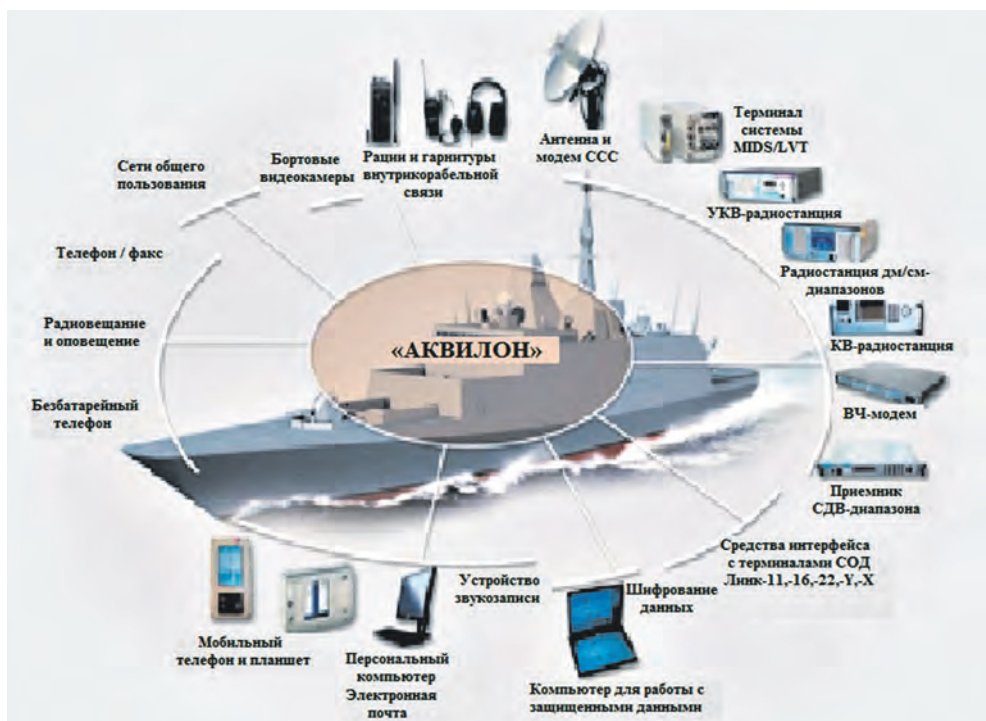
Схема интегрированной корабельной сети связи «Аквилон»
