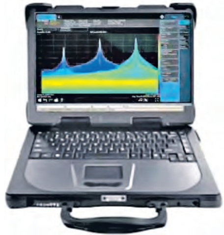
Отображение электромагнитной обстановки на мониторе анализатора спектра
