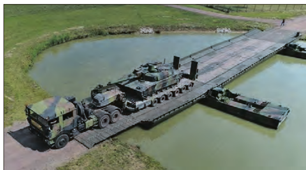
Демонстрация стального моста-ленты SRB французской компании CEFA с нагрузкой (переправа танка «Леклерк» на седельном тягаче)
