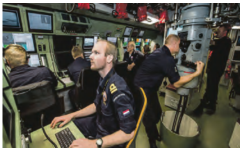
Центральный пост ДЭПЛ типа «Валрус» после модернизации (на переднем плане слева – пульты операторов группы надводной обстановки, справа – командирский перископ)
