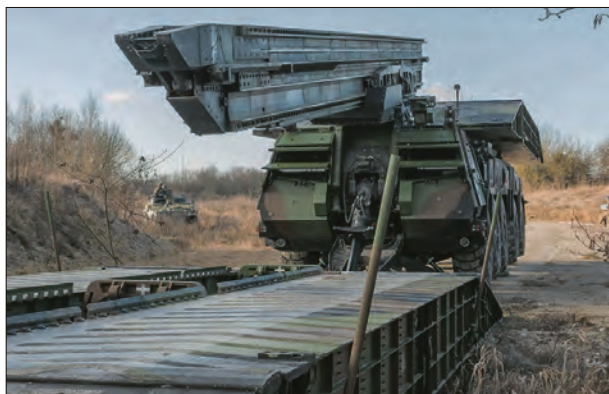
Механизированный мост SPRAT в конфигурации 14,3 м (вверху) и 26 м (внизу)
