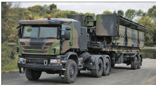
Мост PFM с аппарелью, закрепляемой внутри понтонного звена
