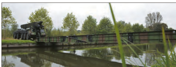
Механизированный мост SPRAT в конфигурации 14,3 м (вверху) и 26 м (внизу)
