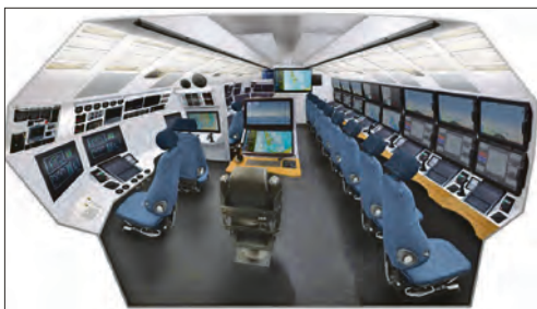
Эскиз центрального поста НАПЛ проекта А26 с пультом командира ПЛ без традиционного перископа
