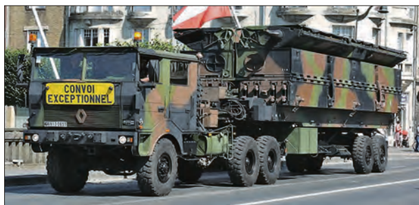
Мост PFM с аппарелью, закрепляемой внутри понтонного звена
