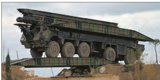
Мостукладчик SPRAT. Базовая машина преодолевает препятствие по уже установленной одной секции моста
