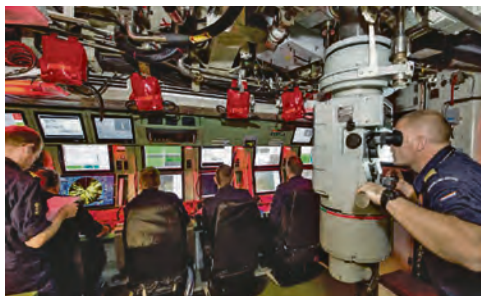
Центральный пост ДЭПЛ типа «Валрус» после модернизации (на переднем плане слева – пульты операторов группы надводной обстановки, справа – командирский перископ)
