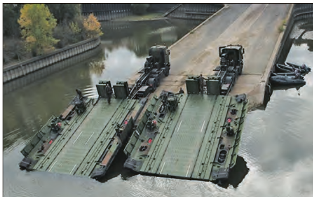
Мост PFM с новой короткой аппарелью, закрепляемой в торцевых частях понтона
