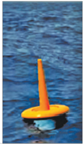
Выдвижение УКВ-антенны радиобуя
