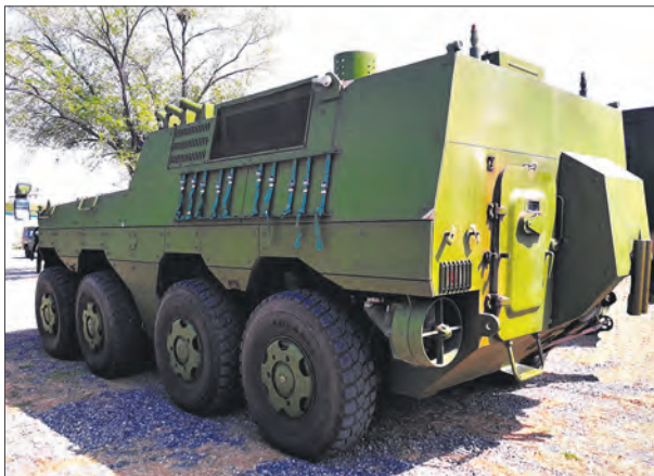
Машина РХ-разведки НОАК на базе колесного бронетранспортера ZBL-09 с дизельным двигателем мощностью 440 л. с.
