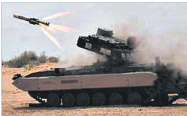
Противотанковый ракетный комплекс «Наг» на базе БМП-2
