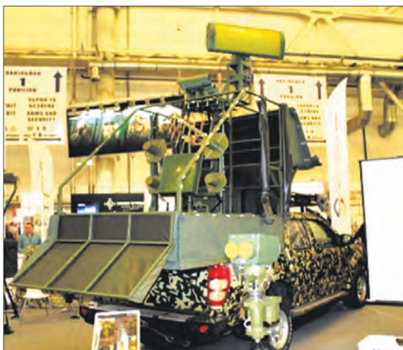
Мобильный комплекс РЭП «Полонез», размещенный на коммерческом автомобиле повышенной проходимости
