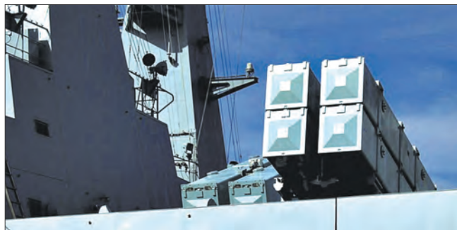
Противокорабельная ракета «Инцзи-83» и пусковые установки ПКР на фрегате типа «Мааньшань»
