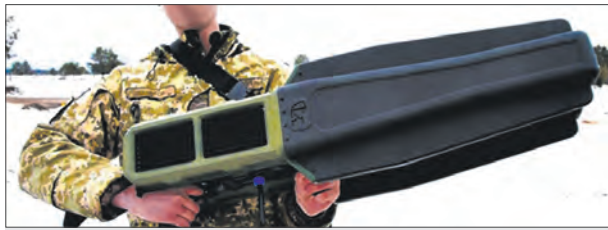
Станция РЭП «Джаммерган-3»
