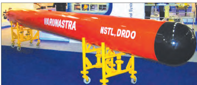
533-мм тяжелая противолодочная торпеда «Варунастра»
