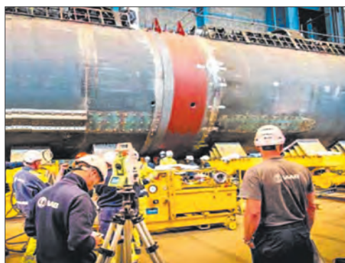
ПЛ типа «Готланд» до и после врезки дополнительной секции в корпус
