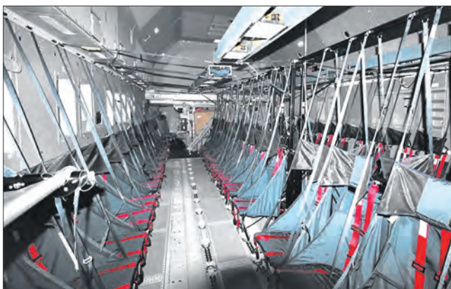
На рисунках (сверху вниз): приборная панель самолета А.400М, грузовой отсек, сиденья для десантников
