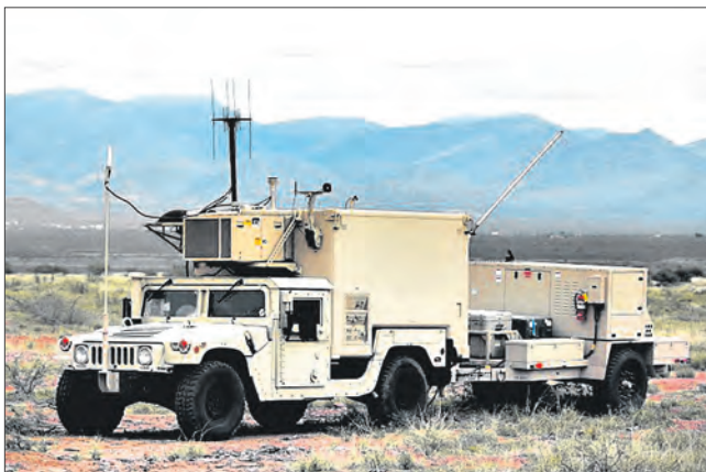
В американских войсках основным мобильным компонентом подсистемы СВ США объединенной автоматизированной территориально-распределенной системы обеспечения разведки и другой информацией являются смонтированные на автомобильном шасси тактические наземные станции TGS (Tactical Ground Station), которые предназначены для сбора от всех доступных средств разведки и других источников, обработки, анализа, обобщения разведсведений и доведения в масштабе времени, близком к реальному, подготовленной развединформации до органов и пунктов управления войсками в интересах решения ими функциональных задач, в том числе проведения информационных операций
