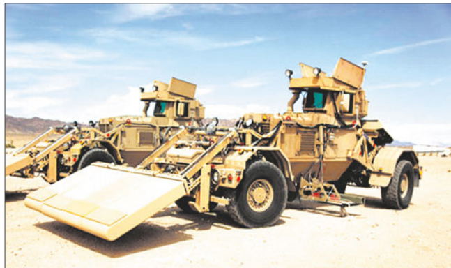
Общий вид броневедомоуля «Хаски» с инфракрасной и радиолокационной аппаратурой поиска мин (вверху) и с гидравлическим поворотным манипулятором (внизу)
