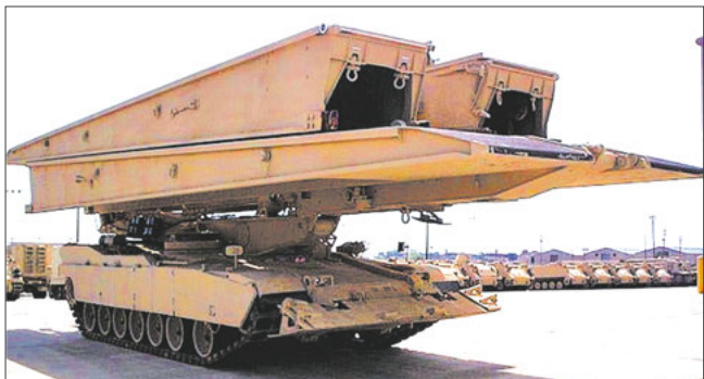
Мостоукладчики XM104 «Вулверин» (вверху) и перспективный XM1074 JABS (внизу)
