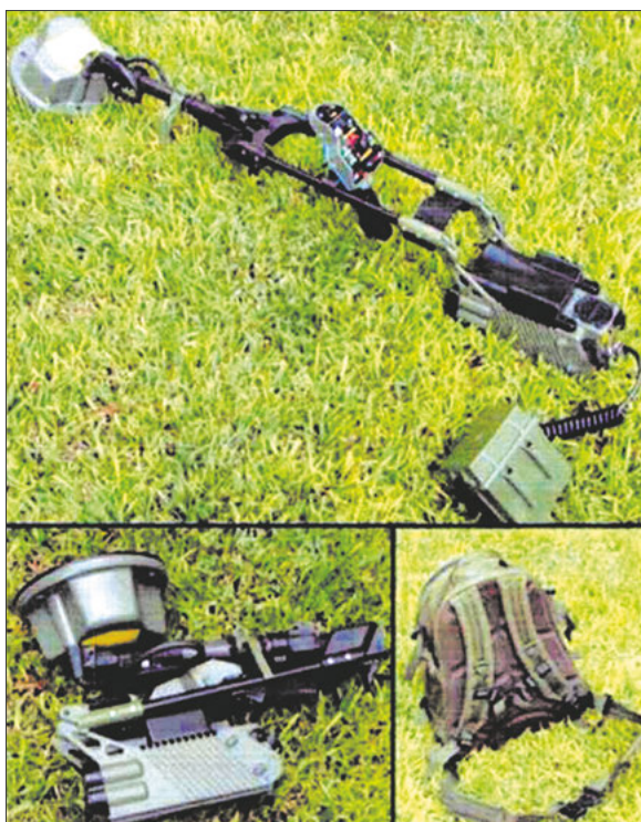
Общий вид миноискателя AN/PSS-14 в боевом (вверху) и походном (внизу) положениях
