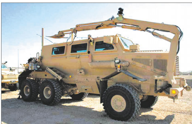
Машина разминирования «Буффало» с манипулятором в транспортном положении
