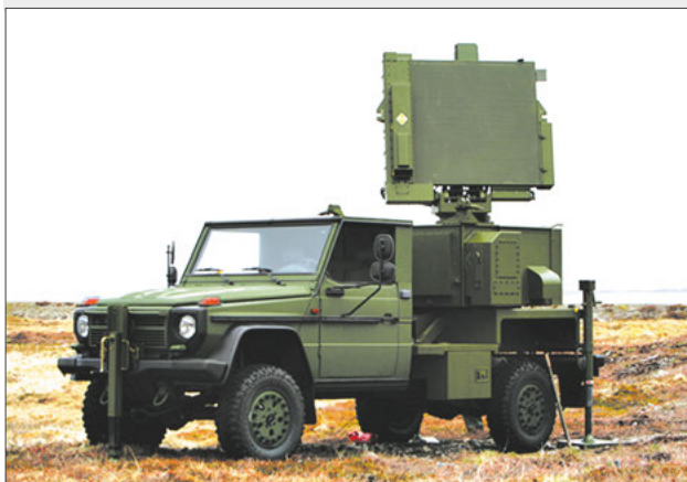
Радиолокационная станция AN/MPQ-64F1 «Сентинел» ближнего радиуса действия (вверху – на прицепе, внизу – на тактическом автомобиле)
