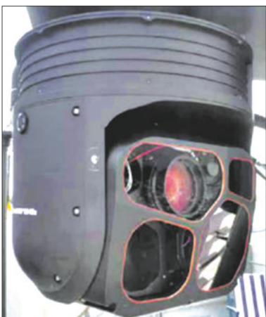
Антенны РЛС «Серчмастер» и оптико-электронная станция «Сафир-380»
