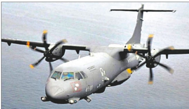
Хвостовая часть самолета P-72A ВМС Италии с антенной магнитометра и носовая – с РЛС «Сиспрей 7300Е» под фюзеляжем и антеннами системы РРТР ALR-733 поборотно
