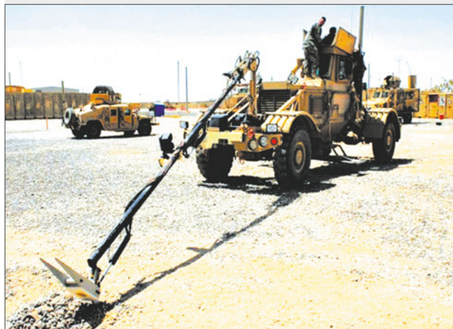
Общий вид броневедомоуля «Хаски» с инфракрасной и радиолокационной аппаратурой поиска мин (вверху) и с гидравлическим поворотным манипулятором (внизу)
