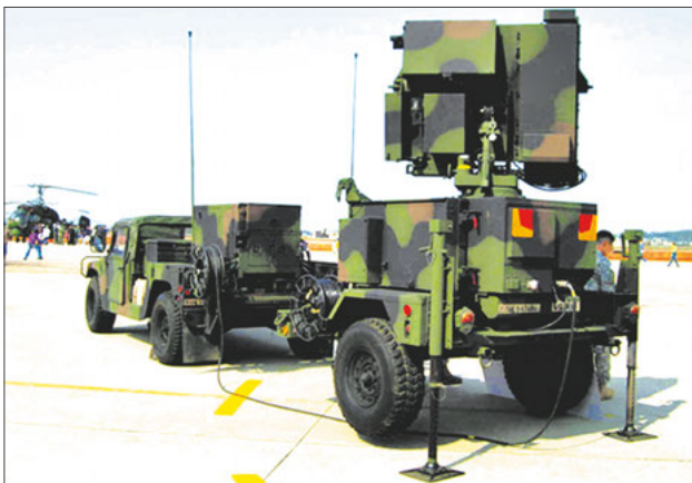
Радиолокационная станция AN/MPQ-64F1 «Сентинел» ближнего радиуса действия (вверху – на прицепе, внизу – на тактическом автомобиле)
