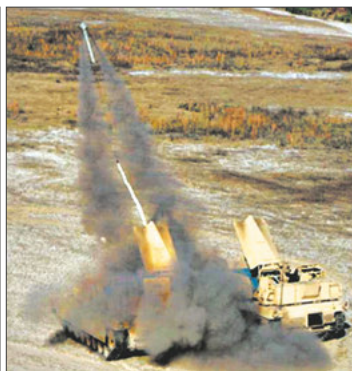
Общий вид машины разграждения XM1150 AVB (слева) и при пуске заряда разминирования (справа)
