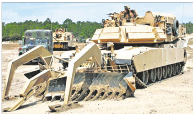
Общий вид машины разграждения XM1150 AVB (слева) и при пуске заряда разминирования (справа)
