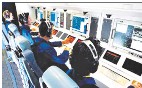
Автоматизированные рабочие места операторов системы «Амаскос» (слева), операторы системы «Фитс» за пультами АРМ, размещенными вдоль борта самолета (справа)
