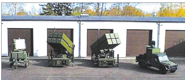
ЗРК НАСАМС-III предназначен для поражения воздушных целей на дальности до 25 км на малых и средних высотах в любых погодных условиях
