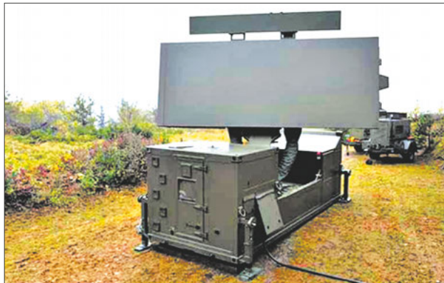
Радиолокационная станция GM-403 «Граунд Мастер» производства «Талес» (Франция). Состоит на вооружении ВС Эстонии
