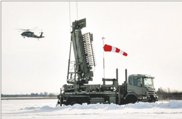
Радиолокационная станция AN/TPS-77MRR в боевом положении. Дальность обнаружения цели от 10 до 470 км
