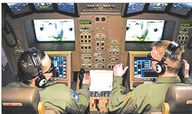
Внешний вид панелей управления и отображения информации поста оператора дозаправки ТЗС КС-46А «Пегас»
