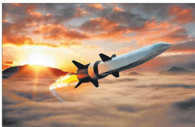
Эскизный проект гиперзвуковой ракеты воздушного базирования с ГПВРД, разрабатываемый компаниями «Рейтеон» и «Нортон-Грумман»
