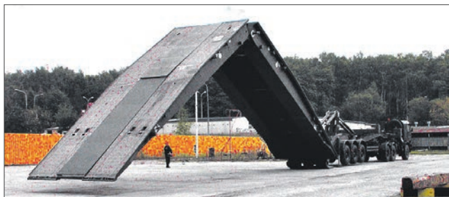
Выкладка механизированного моста МС-20 «Даглезья»
