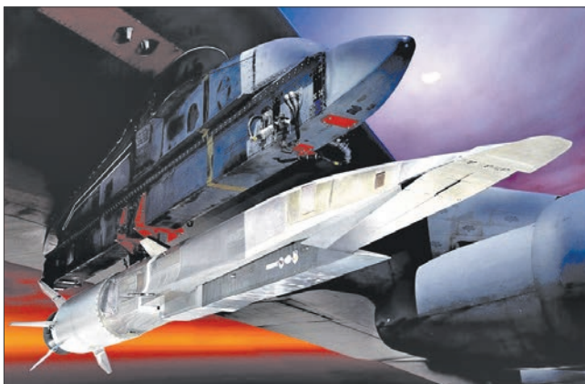
Экспериментальный гиперзвуковой летательный аппарат X-51A на внешнем узле подвески вооружения стратегического бомбардировщика В-52Н
