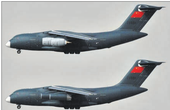
Проекция тяжелого военно-транспортного самолета «Юнь-20» со старыми (Д-30КП-2, вверху) и новыми (WS20, внизу) двигателями
