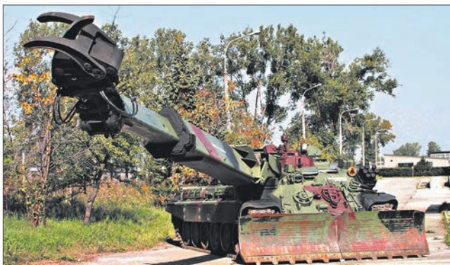
Инженерно-дорожная машина «Бизон-С»
