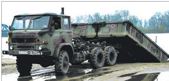
Выкладка звена понтонного моста ПП-64
