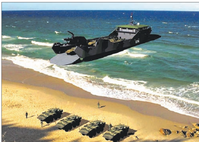
Десантирование подразделения морской пехоты на боевых машинах с легкого десантного корабля через носовую аппарель (эскиз)
