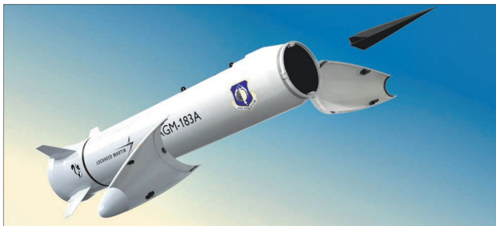
Внешний вид гиперзвуковой ракеты AGM-183A с отделяемым боевым блоком
