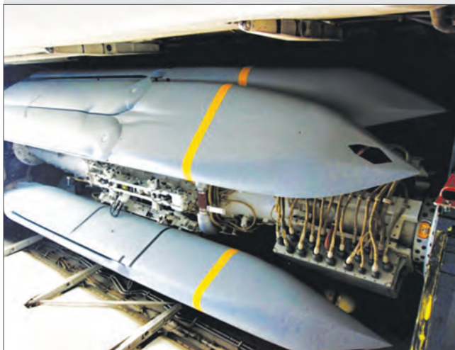
Подвеска топливного бака в переднюю часть центрального отсека (вверху); размещение крылатых ракет воздушного базирования AGM-158 на роторной пусковой установке (внизу)
