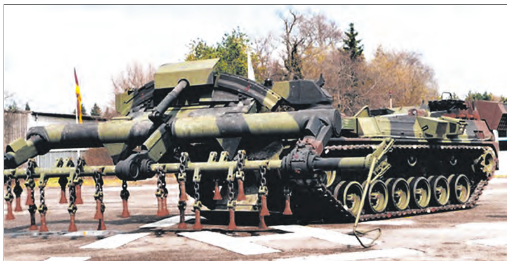
Танковый минный трал «Кайлер»
