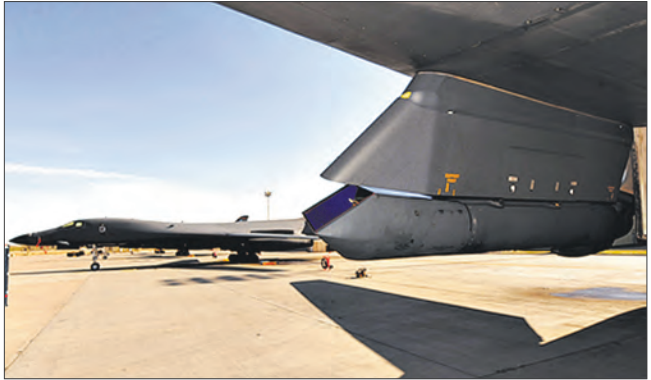
Прицельно-навигационная система «Снайпер-ХР» на вскрытом переднем внешнем узле
