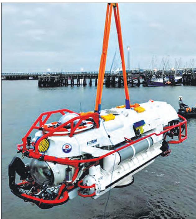
Спасательный аппарат LR11 во время приемочных испытаний в гавани
