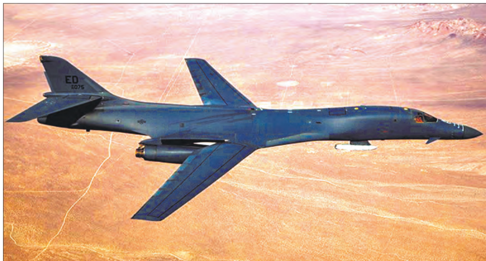
Стратегический бомбардировщик В-1В «Лансер» с крылатой ракетой AGM-158 на внешней подвеске
