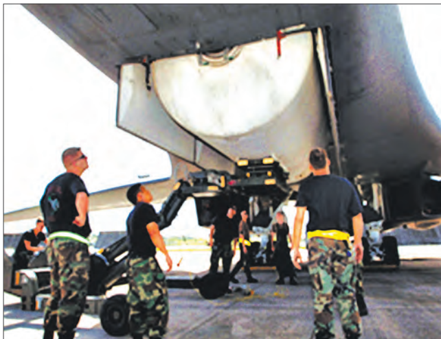
Подвеска топливного бака в переднюю часть центрального отсека (вверху); размещение крылатых ракет воздушного базирования AGM-158 на роторной пусковой установке (внизу)
