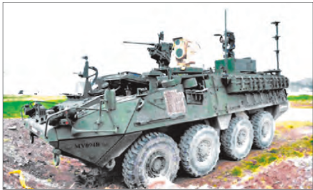
Внешний вид комплекса лазерного оружия «М-Мхел» на базе ББМ «Страйкер»
