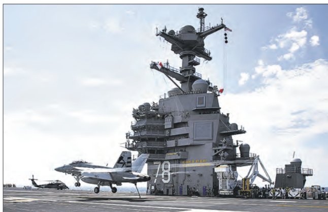
На авианосце «Джеральд Форд» увеличена взлетно-посадочная палуба, установлены электромагнитные катапульты
