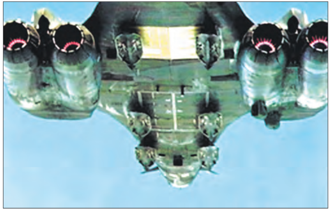
Двухпозиционные внешние пилоны на бомбардировщике В-1В «Лансер»
