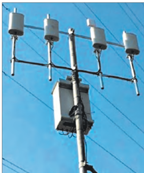
Станция активных помех системы SMJ1890, размещенная в аэропорту имени Давида Бен-Гуриона (Тель-Авив, Израиль)
