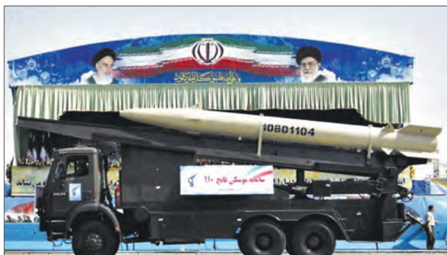
Твердотопливная одноступенчатая ОТР «Фатех-110» с дальностью стрельбы от 150 до 300 км
