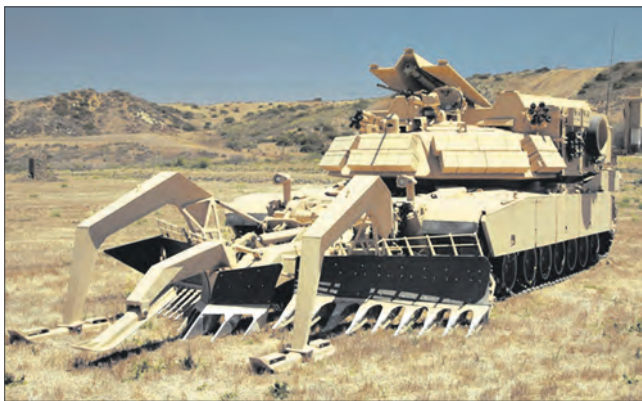
Штурмовая машина разграждения XM1150 AVB, созданная на гусеничном шасси ОБТ M1A1 «Абрамс», с тралом шириной 4,5 м в боевом положении
