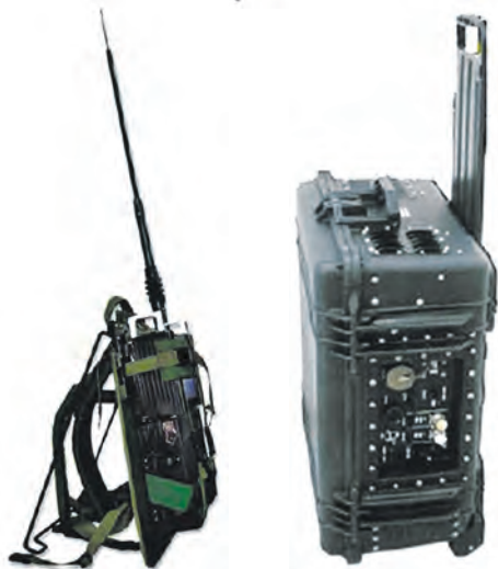
Комплексы защиты от РУМВУ MRJ: А – для защиты бронетехники; Б – для обеспечения безопасности совещаний; В – для защиты пеших подразделений
