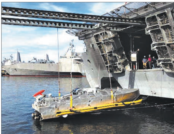
Выгрузка многофункционального безэкипажного катера CUSV из твиндека корабля прибрежной зоны типа «Индепенденс» ВМС США
