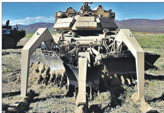
Робототехнический комплекс разминирования с интеллектуальной системой управления. Оператор комплекса находится с пультом ДУ на борту ББМ под защитой брони
