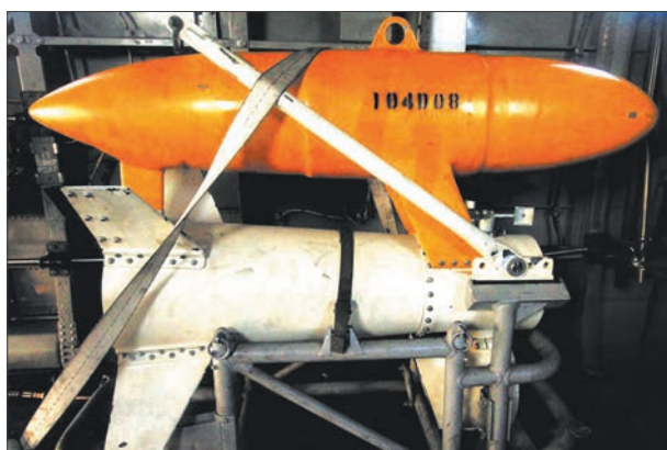
Магнитоакустический буксируемый неконтактный трал Mk 104
