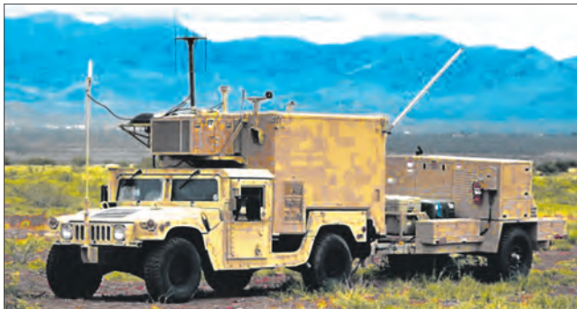
Автомобиль «Хамви» с установленным на него комплектом аппаратуры приема и обработки разведсведений AN/TSQ-179 системы сбора, обработки и распределения разведывательной информации сухопутных войск «Дкгс-А»
