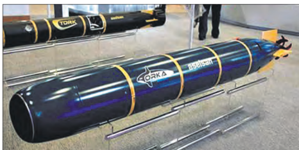
Новая турецкая торпеда «Орка» призвана заменить произведенные в США малогабаритные противолодочные Mk 46 и Mk 54 калибра 324 мм
