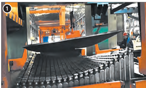
Изгиб листа на трехмерном гидравлическом гибочном станке: 1 – бортовая обшивка (5 060 × 2 250 × 25 мм); 2 – носовая оконечность (1 824 × 1 268 × 16 мм)
