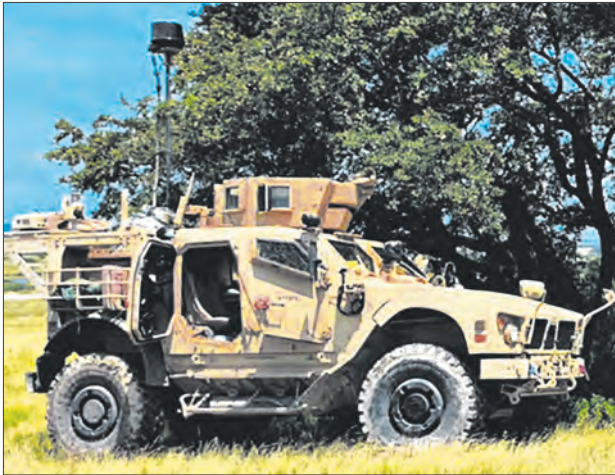
Комплекс РРТР и РЭБ «Профет», установленный на бронев автомобиле типа «М-Атв»
