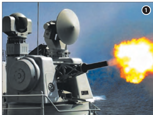
Зенитное вооружение самообороны ЭМ УРО типа «Наньчан»: 1 – 30-мм ЗАК «Тип 1130»; 2 – пакетная ПУ ЗРК HQ-10
