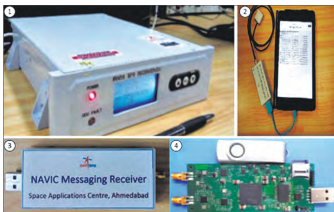
Навигационное оборудование КРНС «Навик»: 1 – корабельный терминал; 2–4 – элементы внешнего приемного устройства для мобильных терминалов
