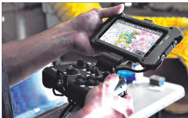
Специальный джойстик PUCK для управления беспилотными системами, сопряженный со смартфоном через приложение ATAK
