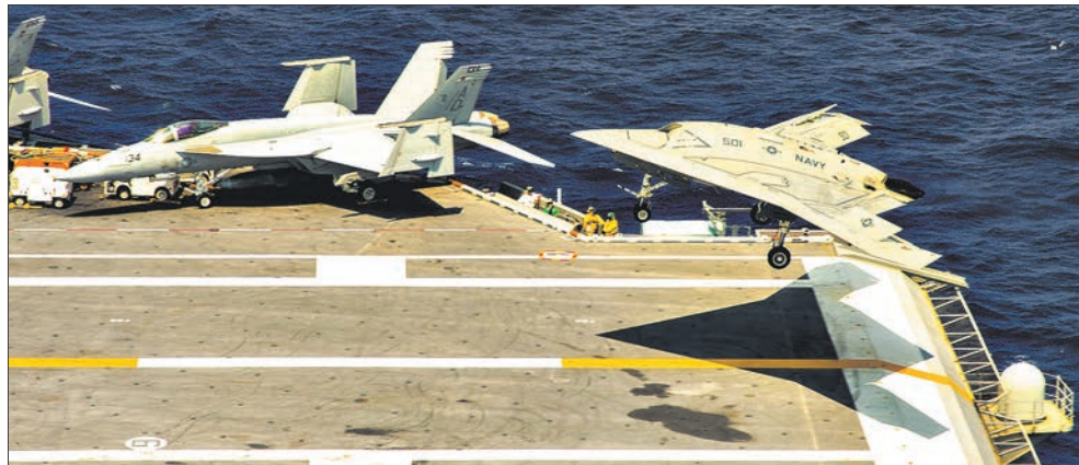
Посадка на палубу корабля экспериментального БПЛА X-47B
