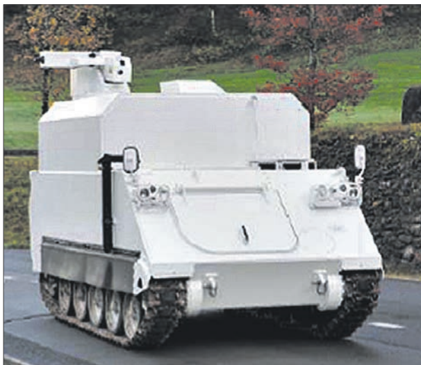
Мобильная лазерная установка мощностью 1 кВт для действия на поле боя
