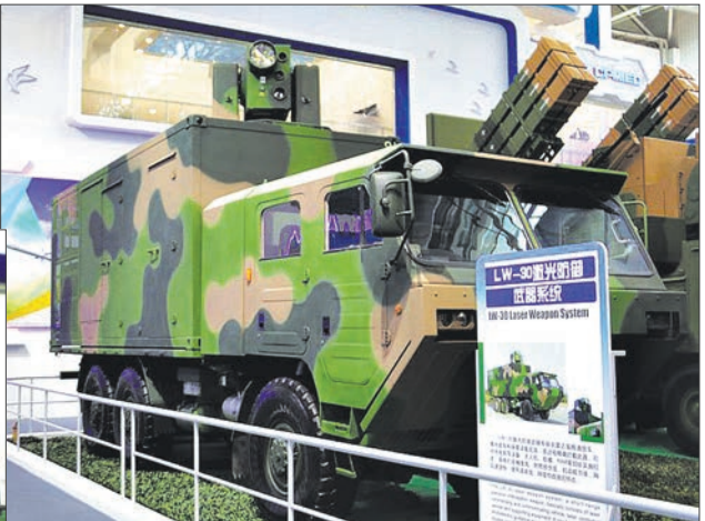
Выставочный образец китайского мобильного комплекса лазерного оружия LW-30 заявленной мощностью 30 кВт
