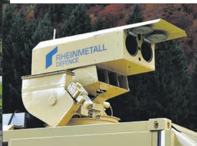
Мобильный комплекс лазерного оружия мощностью 20 кВт («Рейнметалл»)
