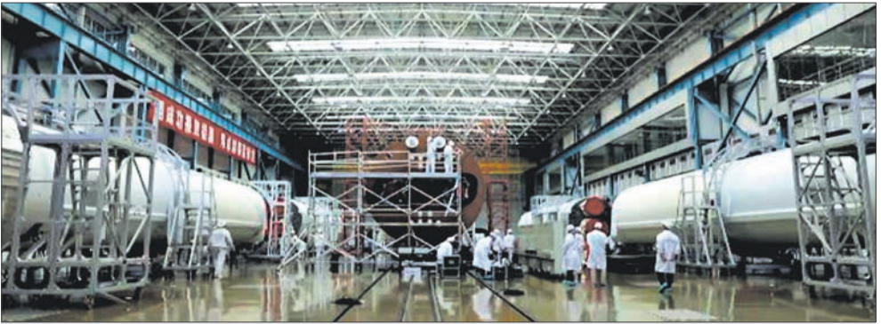
Сборка ракет-носителей тяжелого класса «Чанчжэн-5» на заводе в г. Тяньцзинь
