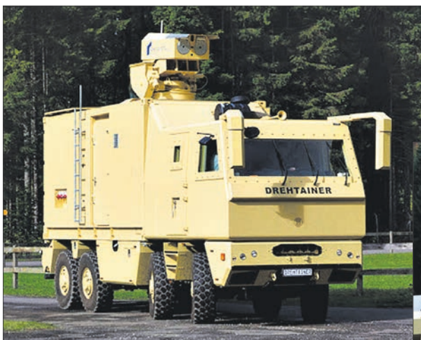
Мобильный комплекс лазерного оружия мощностью 20 кВт («Рейнметалл»)
