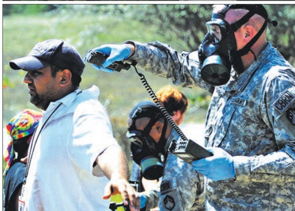
Измерение степени облучения личного состава и гражданских лиц приборами радиационной разведки
