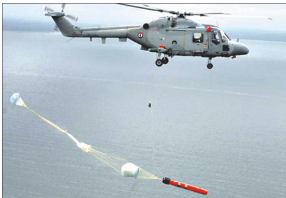
Противолодочная торпедa MU90 «Импакт» на подвеске вертолета NH-90 (вверху) и ее пуск с противолодочного вертолета «Линкс»
