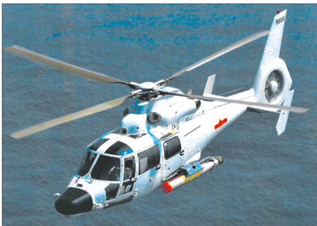
Противолодочная торпеда Yu-7 на пилоне противолодочного вертолета Z-9ES
