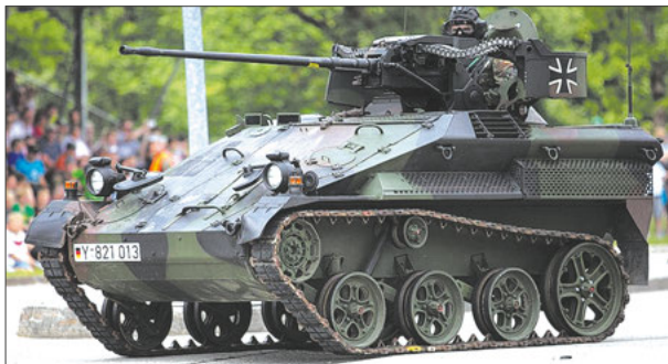
БМД «Визель-1» А4МК с 20-мм автоматической пушкой
