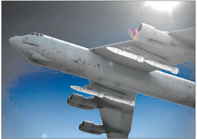
Вариант размещения ГАБР AGM-183 «Аррв» на стратегическом бомбардировщике В-52Н
