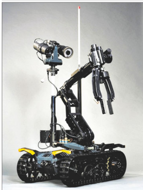
Дистанционно управляемая машина RMI с рабочим оборудованием
