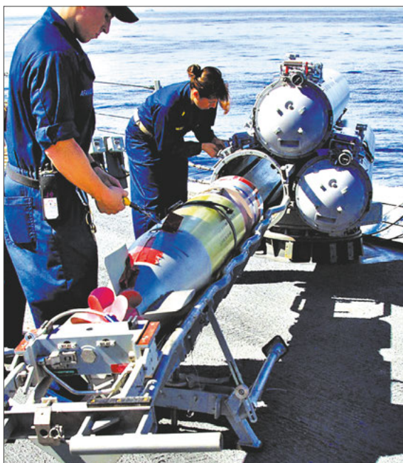
Загрузка противолодочной торпеды Mk 46 мод. 5А в 324-мм торпедный аппарат Mk 32 эсминца УРО
