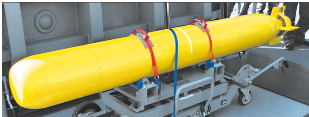
Противолодочная торпеда «Тип 97» с практической головной частью на транспортировочной тележке
