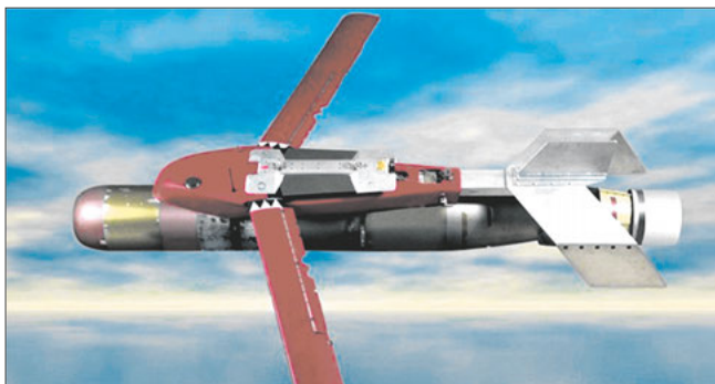
Противолодочная торпеда Mk 54 мод. 1 «Мако» с оборудованием высотного сброса ALA
