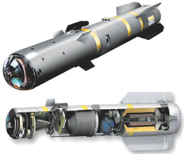
Внешний вид и компоновка управляемой ракеты AGM-179 «Джагг»
