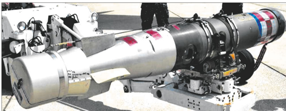
Противолодочная торпеда Mk 54 мод. 1 «Мако» на манипуляторе погрузочного устройства
