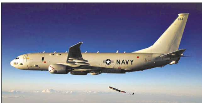
Запуск противолодочной торпеды Mk 54 с борта самолета базовой патрульной авиации P-8А «Посейдон»
