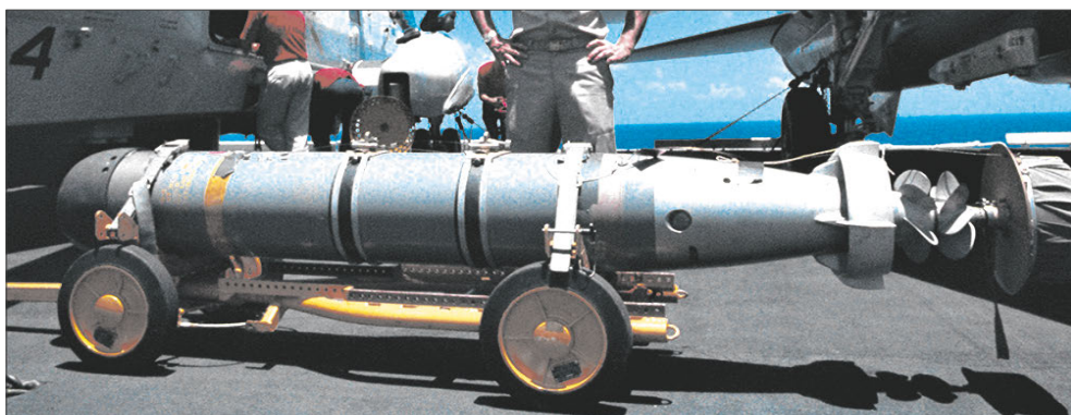
Противолодочная торпеда Mk 46 мод. 5А во время погрузки на противолодочный вертолет
