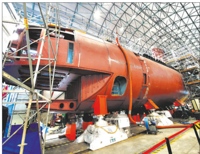
Строительство дизель-электрической подводной лодки S-81 «Исаак Пераль» на заводе судостроительного объединения «Навантия»
