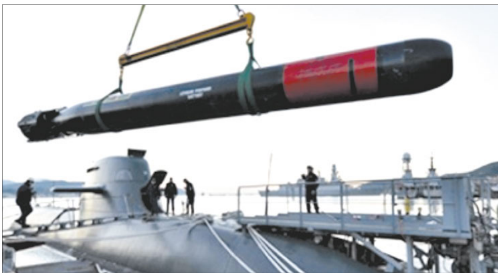
Универсальная торпеда DM2A3 «Зеехехт» мод. 4 при погрузке на ДЭПЛ
