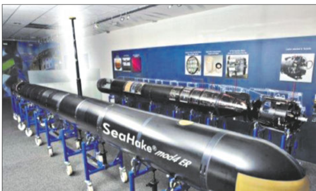
Универсальная торпеда DM2A4 «Си Хэйк» мод. 4 ER с антенной для системы GPS-навигации
