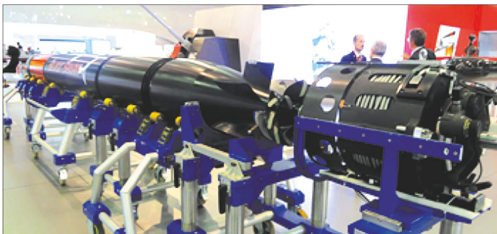
Универсальная торпеда А184 «Блэк Шарк» на выставочном стенде (вид со стороны катушки с кабелем телеуправления)
