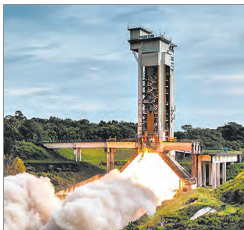
Гвианский космический центр (г. Куру, заморский департамент Французская Гвиана): запуск ракеты-носителя «Ариан-5» (август 2016 года, слева) и стендовые испытания двигателя P120C для ракеты-носителя «Ариан-6» (июль 2018 года, справа)
