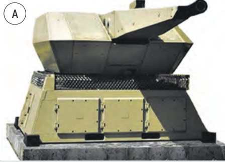
А – внешний вид ЗАК «Мантис»; Б – снаряд PMD 062 в разрезе
