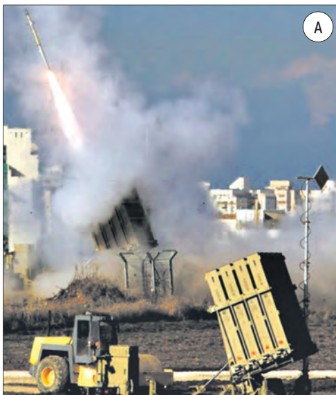
Внешний вид основных элементов ЗРК «Айрон дом»: А – пусковая установка; Б – многофункциональная РЛС EL/M-2084; В – пункт боевого управления
