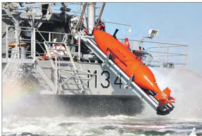
Учебно-боевое применение автономного необитаемого подводного аппарата «Хугин-1000» с борта минно-трального корабля типа «Оксей»
