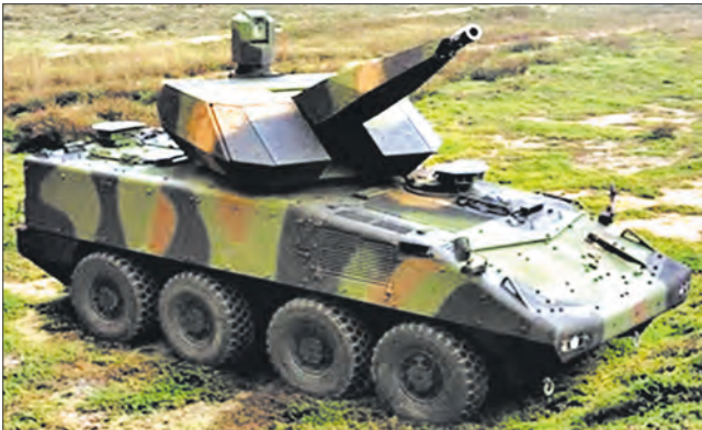
Внешний вид зенитной артиллерийской установки «Скайрейнджер», разработанной на базе БМ «Пирана»
