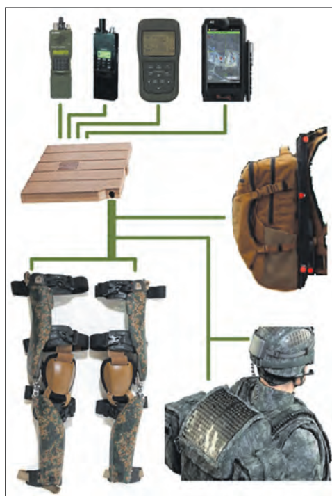
Структурная схема централизованного энергоснабжения боевого комплекса пехотинца
