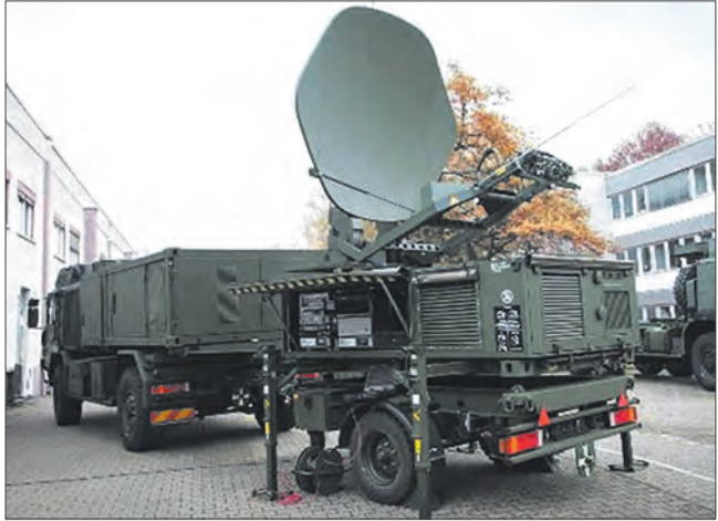
Станция управления, связи и обработки информации из состава мобильного комплекса системы «Агс»
