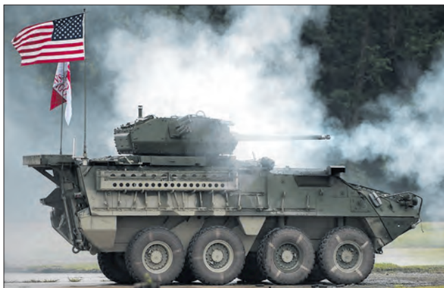
Бронетранспортер «Страйкер» с 30-мм автоматической пушкой
