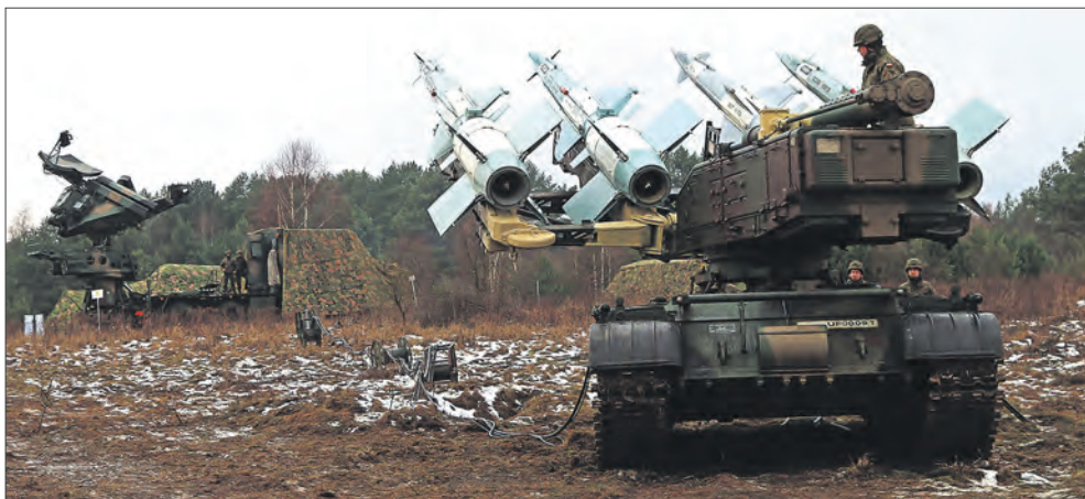
Польские зенитчики на учениях. На переднем плане пусковая установка ЗРК малой дальности С-125 Newa-SC
