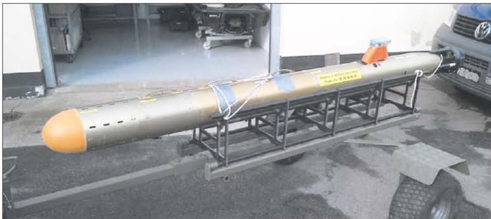
АПА «Гави» может использоваться как гидроакустическая цель при проведении тренировок гидроакустиков
