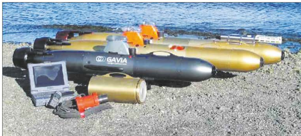
Модульность позволяет в кратчайшие сроки изменить предназначение АПА непосредственно в полевых условиях с помощью замены и добавления модулей
