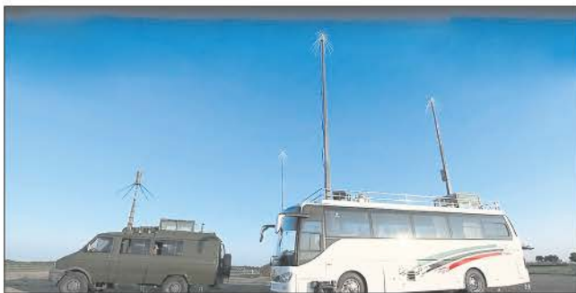
Мобильная аппаратная связи на базе микроавтобуса (слева) и штабной авиационный диспетчерский пункт в автобусе (справа)
