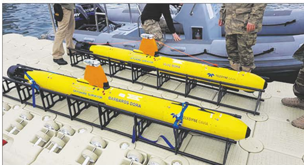
Специалисты ВМС Турции готовят автономные подводные аппараты «Гавиа» к обследованию морского дна в заданном районе
