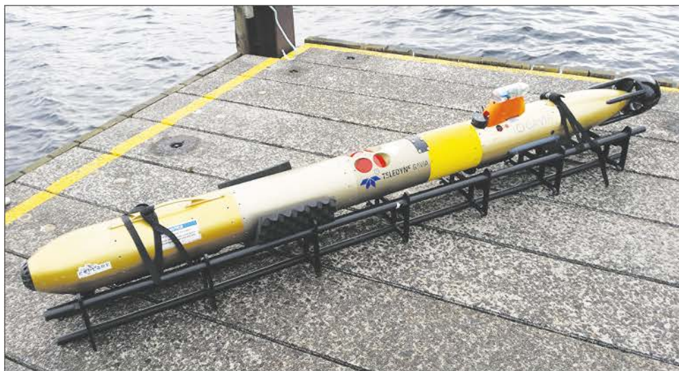
Автономный подводный аппарат «Гавиа» состоит на вооружении многих стран, в том числе входящих в НАТО, и выполняет в основном задачи поиска мин и различных объектов на дне
