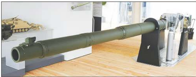
Демонстрационный образец 130-мм гладкоствольной танковой пушки фирмы «Рейнметалл»
