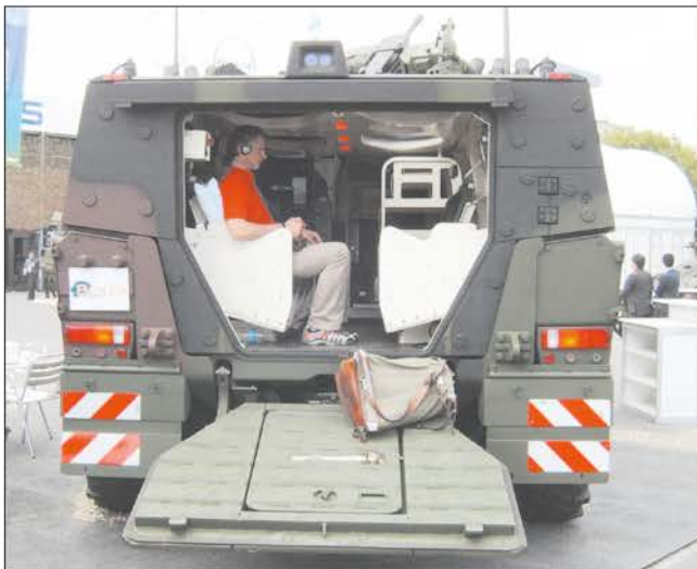
Санитарный автомобиль на базе бронетранспортера «Боксер» в исполнении для транспортировки сидячих раненых
