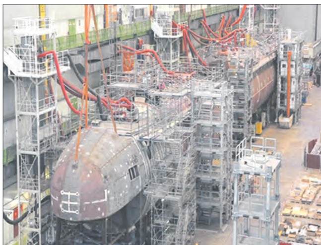
Арсенал судостроительного объединения DCNS в г. Шербур является важнейшим элементом ВПК Франции. Производится стыковка двух половин корпуса многоцелевой атомной подводной лодки «Сюффрен» (проект «Барракуда»), передача которой ВМС Франции запланирована на 2018 год
