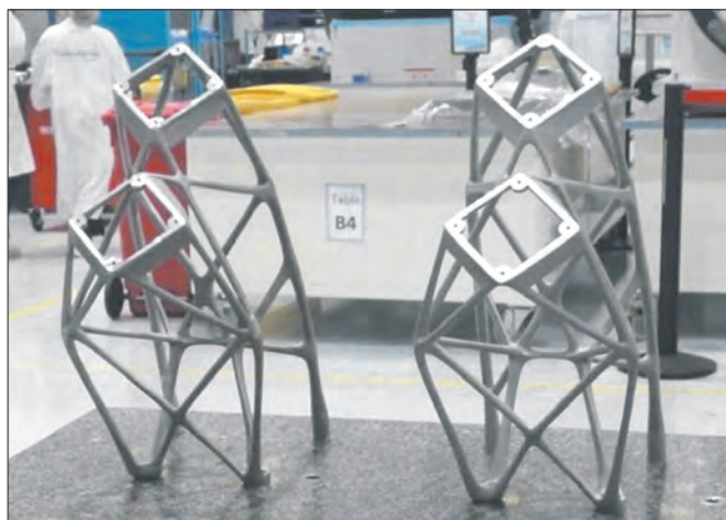
При создании алюминиевых опор спутниковых антенн ИСЗ Koreasat-5A и -7 применялась технология 3D-печати
