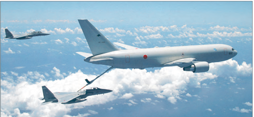
Стратегический самолет-заправщик KC-767J производит дозаправку топливом в воздухе истребителей F-15
