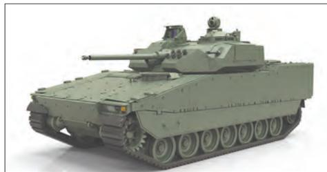
CV-90 Mk 4 оборудована новым двигателем производства шведской фирмы «Скания» мощностью 1 000 л. с. и модернизированной мощной трансмиссией X300. Боевая масса БММ увеличена с 35 до 37 т, это означает, что ее пользователи получают 2 т дополнительной полезной нагрузки без снижения прочности машины и с сохранением уровня защиты.
