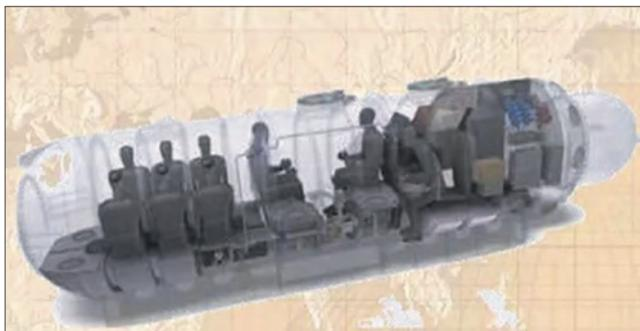
*Схема внутреннего устройства перспективного батискафа, разрабатываемого фирмой «Локхид-Мартин» для ВМС США. Он позволит военнослужащим сил специальных операций находиться внутри судна в процессе движения без специального снаряжения*
