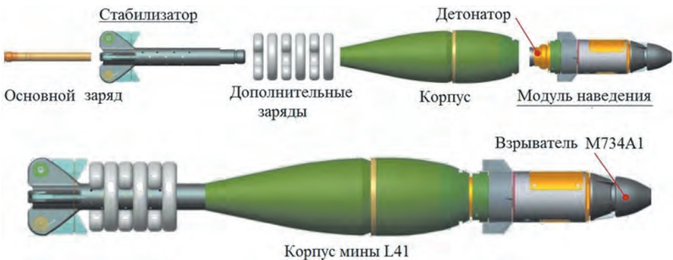
Основные элементы 81-мм мины, разрабатываемой по программе «Ркгм»
