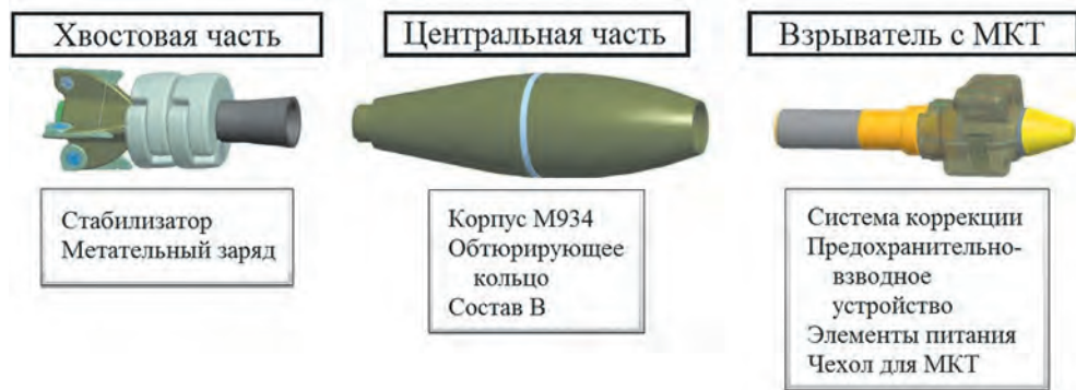
Основные элементы 120-мм управляемой мины XM395 перед стрельбой, разрабатываемой в рамках программы «Апми»
