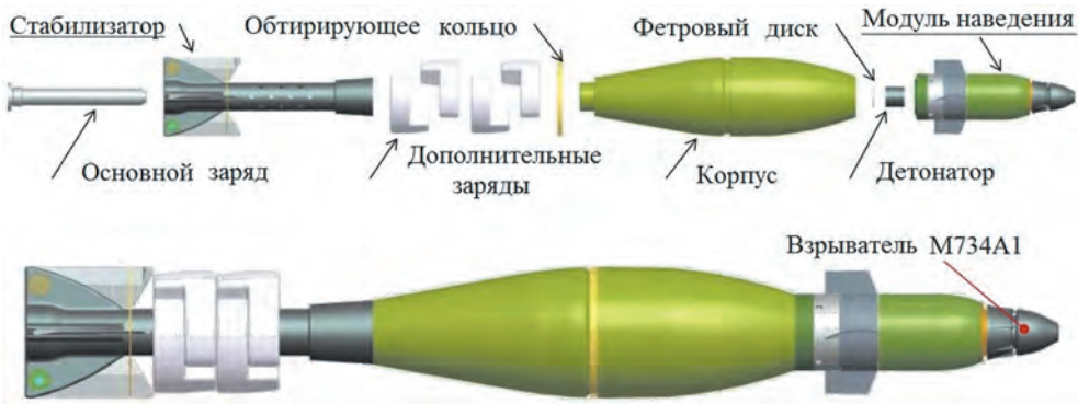
Основные элементы 120-мм мины, разрабатываемой по программе «Ркгм»
