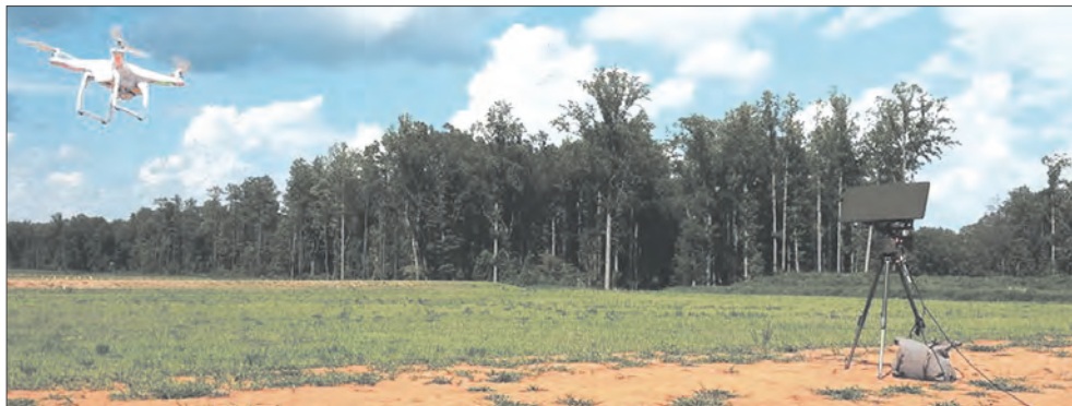
Портативная РЛС системы противодействия мини-БЛА «Дроун гард»
