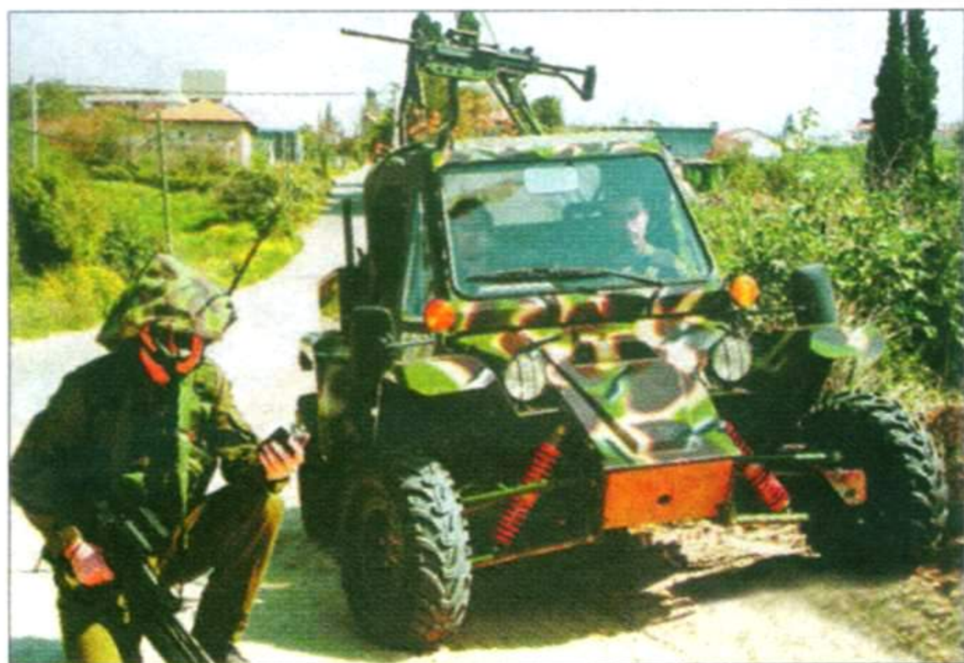
Дистанционно управляемая машина «Гардиум» Mk 1 (вверху) разработана на шасси багги ТМ2 «Томкар»
