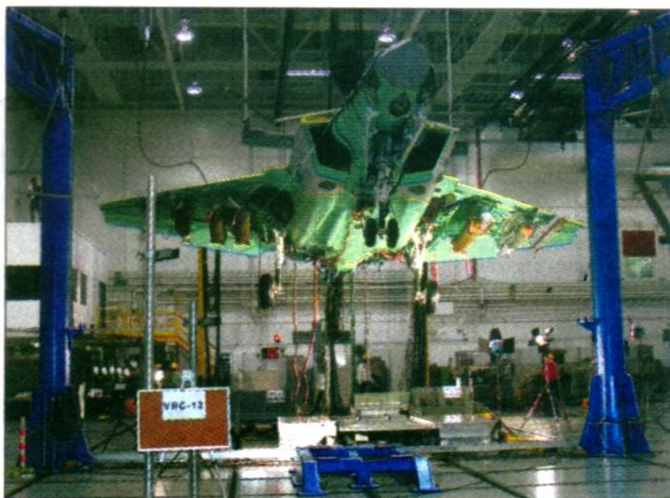
Статические испытания прочности конструкции истребителя F-35 (имитация жесткой посадки на палубу корабля)
