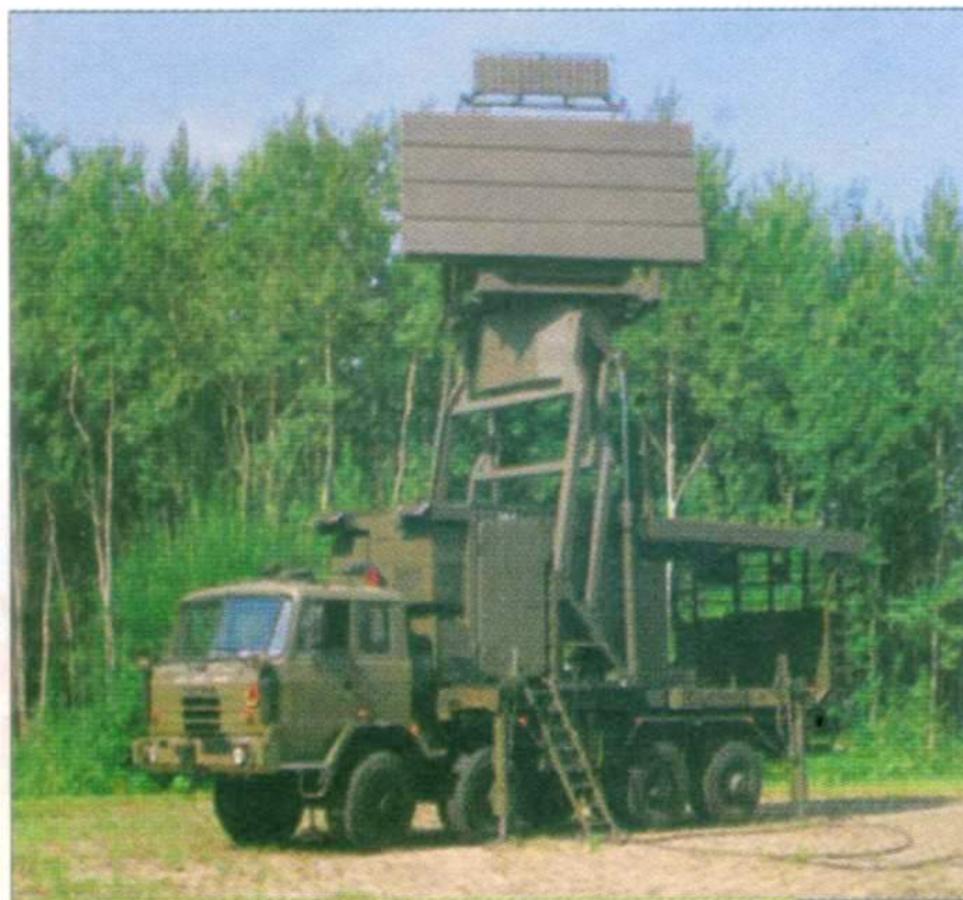
РЛС TRS-15 «Одра» на базе грузового автомобиля повышенной проходимости «Татра»
