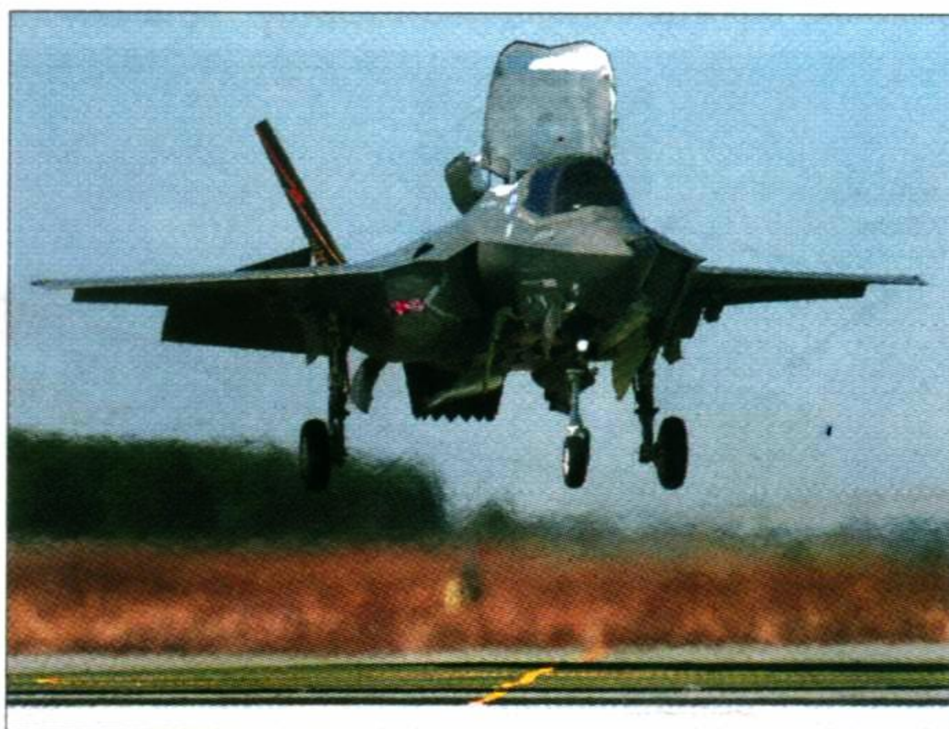
Тактический истребитель с коротким или вертикальным взлетом и посадкой F-35B в режиме висения
