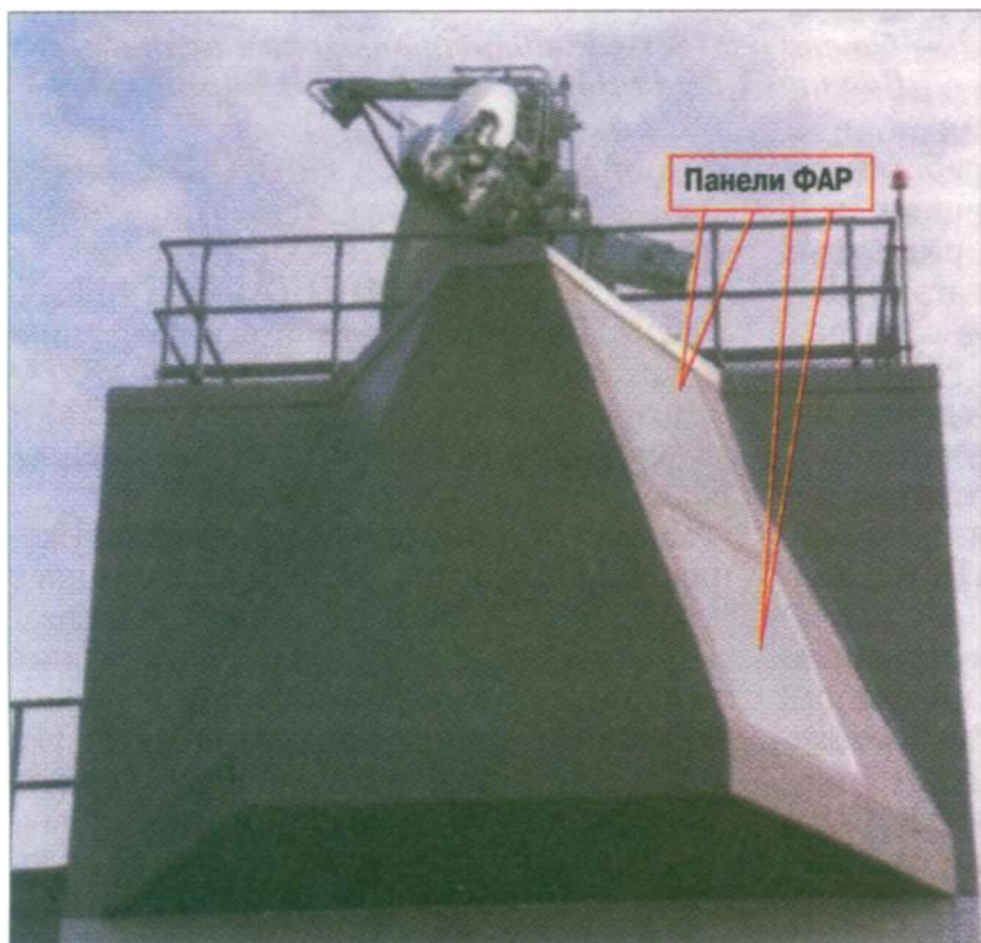
Антенная система многофункциональной РЛС AN/SPY-5 на береговом стенде
