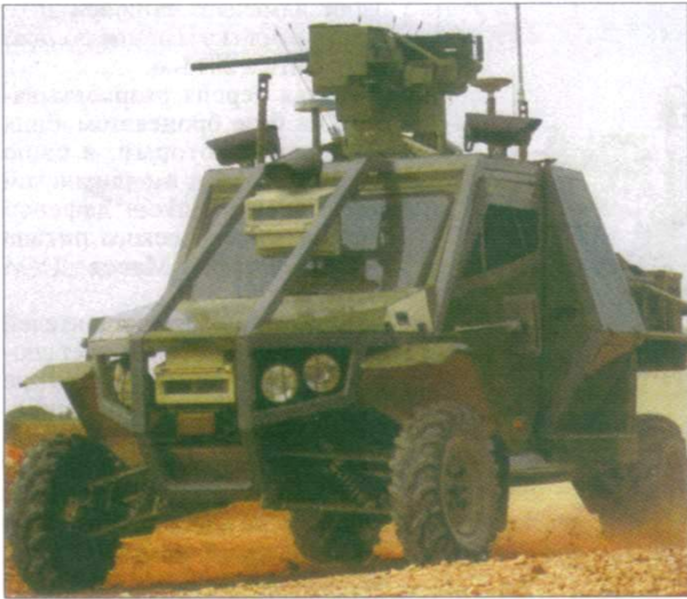
Дистанционно управляемая машина «Гардиум» Mk 2, оснащенная модулем вооружения «Мини-Самсон» (слева) и подъемно-мачтовым устройством с оптоэлектронной станцией (справа)
