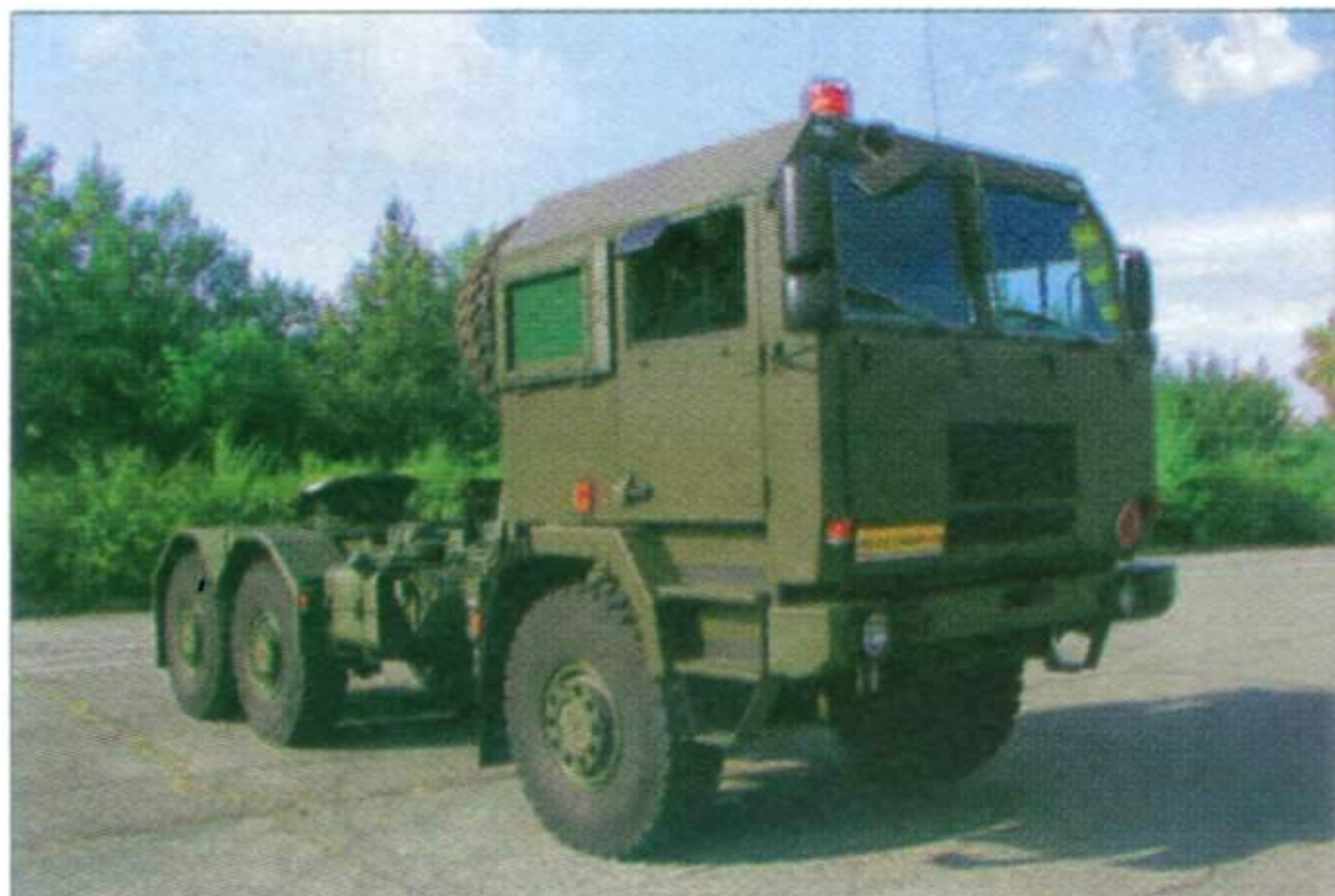
Трехосный грузовой автомобиль повышенной проходимости Jelcz P662D.43 (6 x 6)
