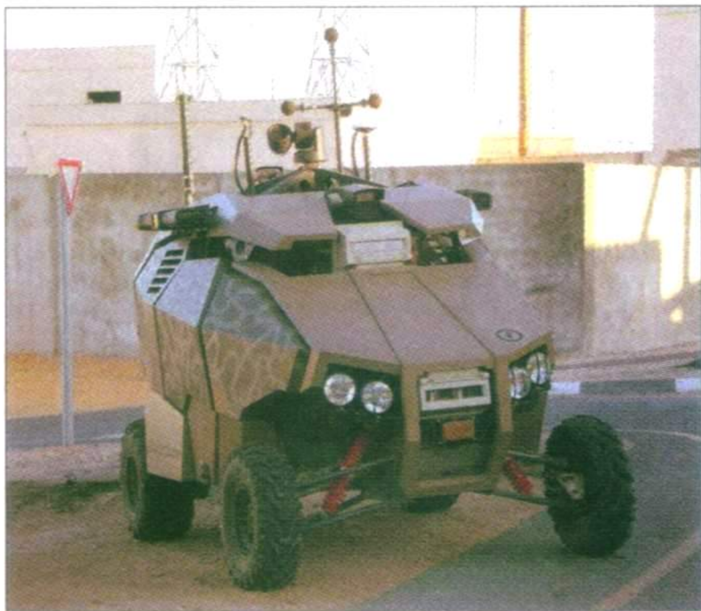
Дистанционно управляемая машина «Гардиум» Mk 1 (вверху) разработана на шасси багги ТМ2 «Томкар»
