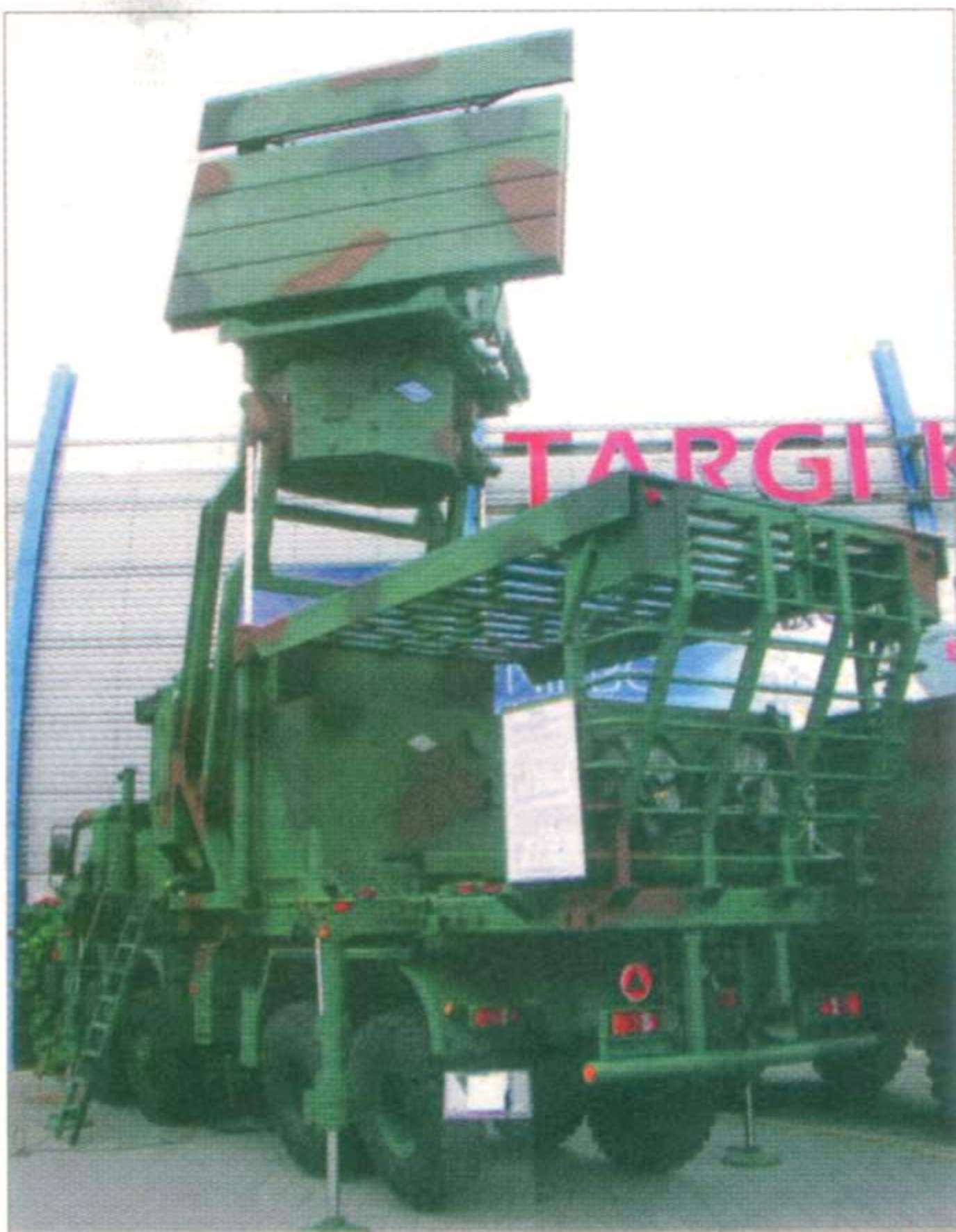
Радиолокационная станция TRS-15 «Одра» на базе грузового автомобиля повышенной проходимости Jelcz P882D.34
