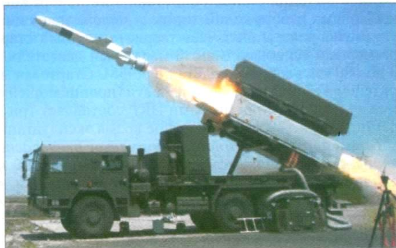
Пуск ПКР NSM с мобильной ПУ на базе трехосного грузового автомобиля повышенной проходимости Jelcz P662D.43 (6 x 6)
