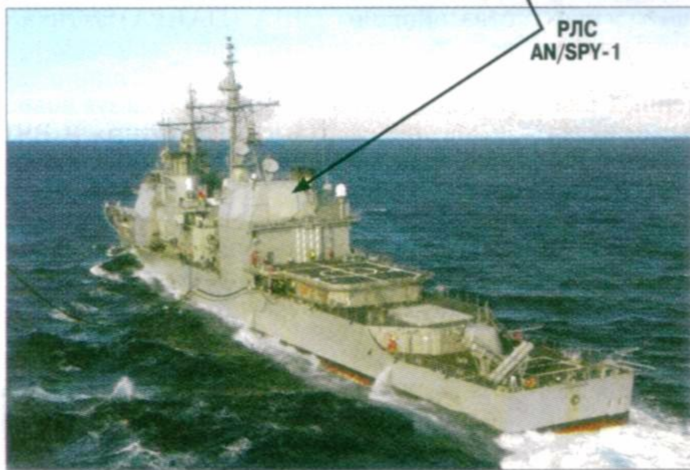
Расположение многофункциональной радиолокационной станции AN/SPY-1 на крейсере УРО CG-69 «Виксбург»
