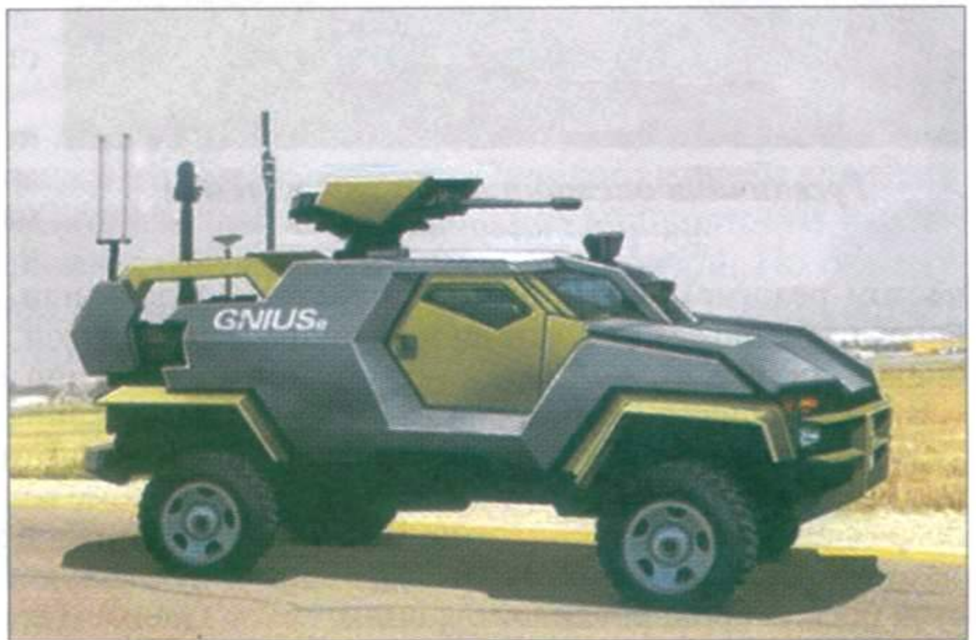
Дистанционно управляемая машина «Гардиум» Mk 3 (концептуальный облик вверху) создается на базе броневедомобиля «Сандкэт» (внизу)
