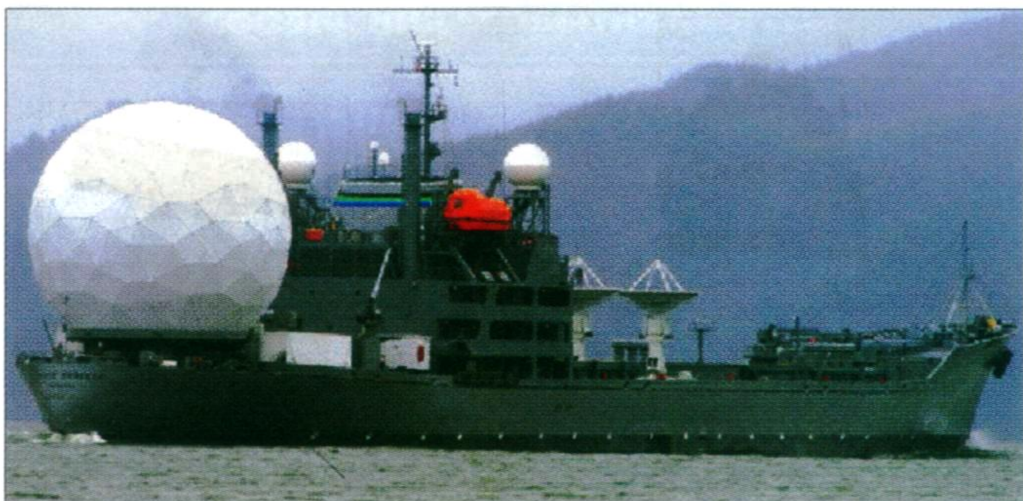
Корабль измерительного комплекса «Пасифик Трекер» ВМС США с РЛС XTR-1
