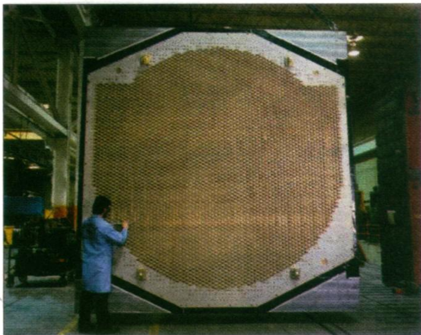
Вид панели фазированной антенной решетки с приемопередающими модулями РЛС AN/SPY-1
