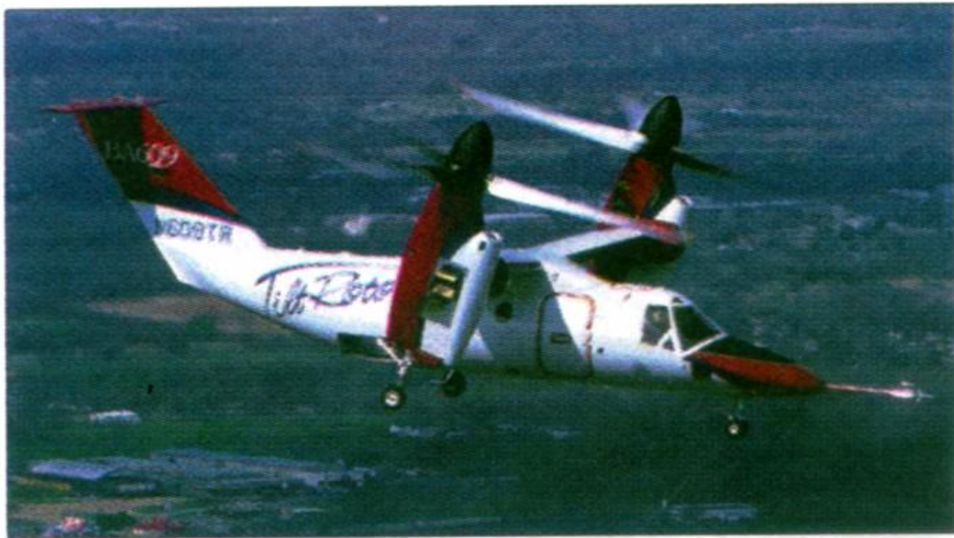
Самолет BA-609 с коротким или вертикальным взлетом и посадкой, оснащенный поворотными турбовинтовыми двигателями
