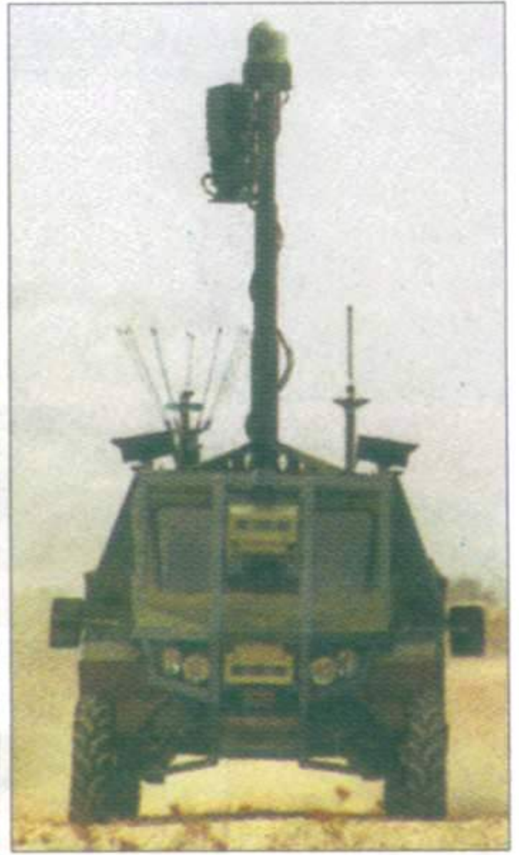
Дистанционно управляемая машина «Гардиум» Mk 2, оснащенная модулем вооружения «Мини-Самсон» (слева) и подъемно-мачтовым устройством с оптоэлектронной станцией (справа)
