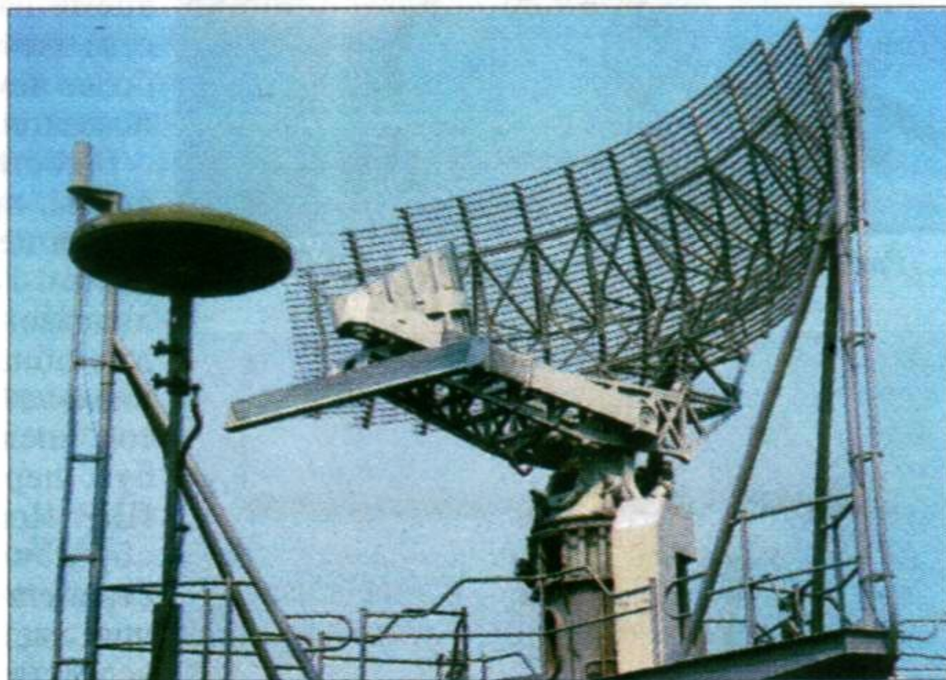
Радиолокационная станция освещения воздушной и надводной обстановки AN/SPS-49
