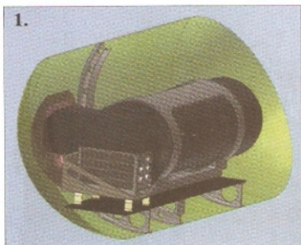
Компоновка и варианты размещения системы MANTA: 1 и 2 – внутри самолета; 3 – в подвесном контейнере
