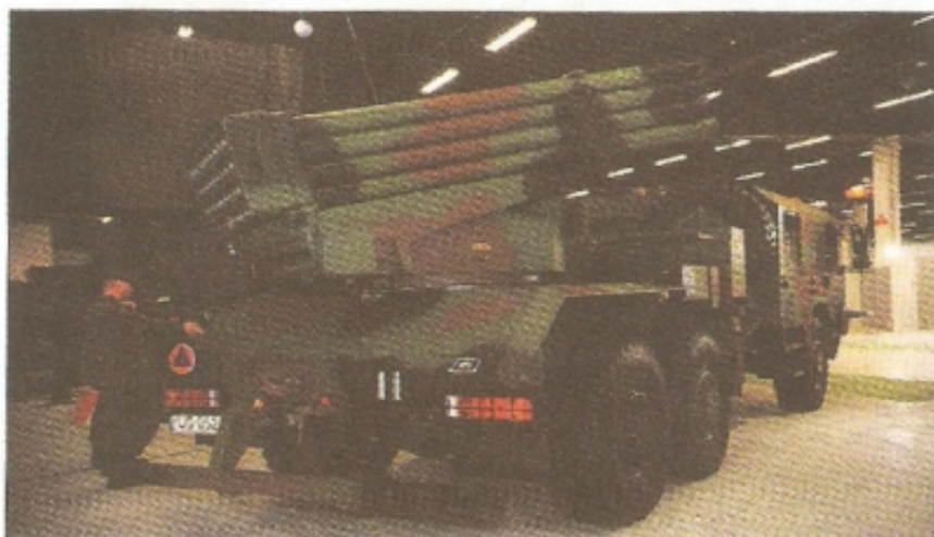
Польская 122-мм РСЗО WR-40 «Лангуст» (на базе автомобиля Jelcz P662D.35)
