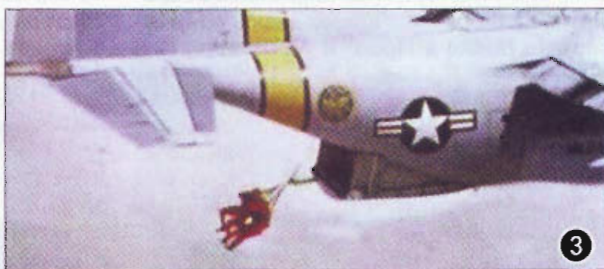
Принцип работы системы «Фултона»: 1 – подъем аэростата; 2 – подготовленный к эвакуации военнослужащий; 3 – втягивание человека на борт самолета
