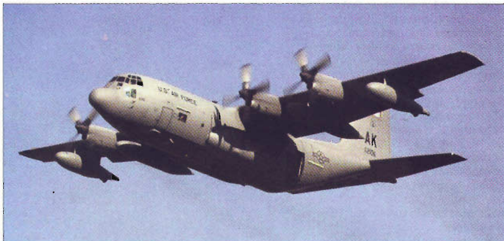
В 1998 году на самолетах HC-130H были демонтированы система эвакуации STARS и обтекатели астроориентатора ARD-17
