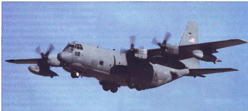
Одна из первых модификаций самолета ССО С-130Е «Комбат Тэлон» («Ривет Ярд») имела подкрыльевые топливные баки
