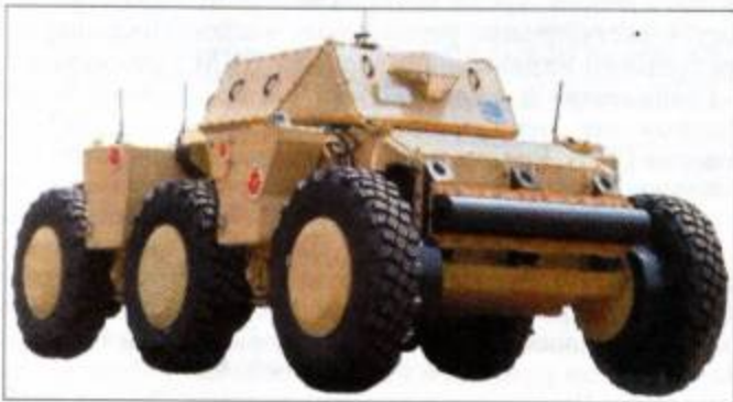
Дистанционно управляемая машина APD является усовершенствованным вариантом ДУМ «Крашер» (ее максимальная скорость передвижения 80 км/ч)
