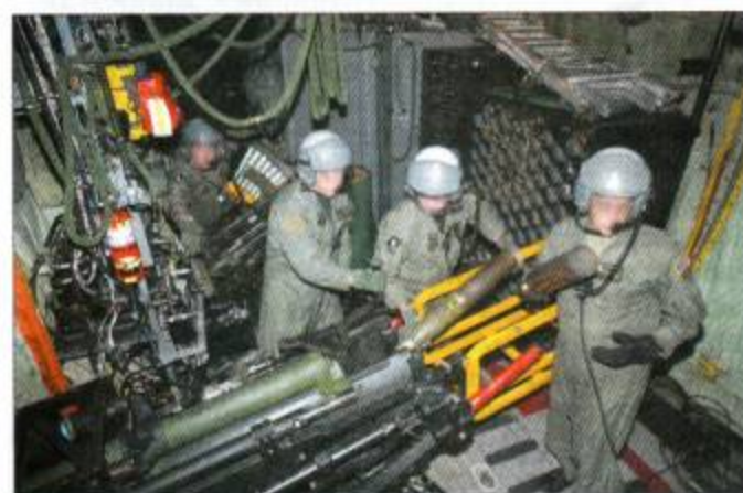
Огневая поддержка групп СО осуществляется в основном самолетами АС-130Н «Спектр» и АС-130У «Спуки», имеющих в составе бортового вооружения 25-мм пятиствольную и 40-мм пушки, а также 105-мм гаубицу
