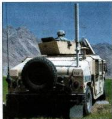
Система РЭВ CREW-Duke предназначена для подавления радиоуправляемых самодельных взрывных устройств противника
