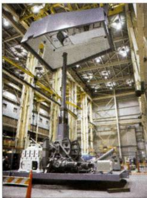
Сборка артиллерийской установки AGS (Advanced Gun System) ЭМ УРО «Замволт» (DDG-1000)
