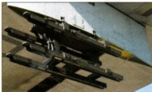
Пусковое устройство M299 с цифровым интерфейсом для подвески четырех УР
