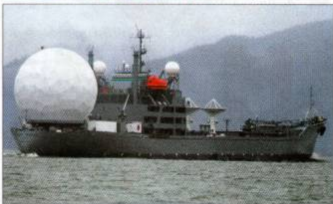
Транспортабельная измерительная РЛС XTR-1 на испытательном полигоне (вверху) и на борту корабля «Пасифик трекер»
