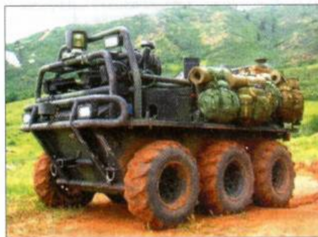
ДУМ SMSS предназначена для транспортировки боеприпасов и материально-технических средств отделения численностью до 10 человек
