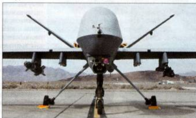
БЛА MQ-9 «Рипер», оснащенный оптоэлектронной системой MTS-B (блок с сенсорами размещен в нижней носовой части)
