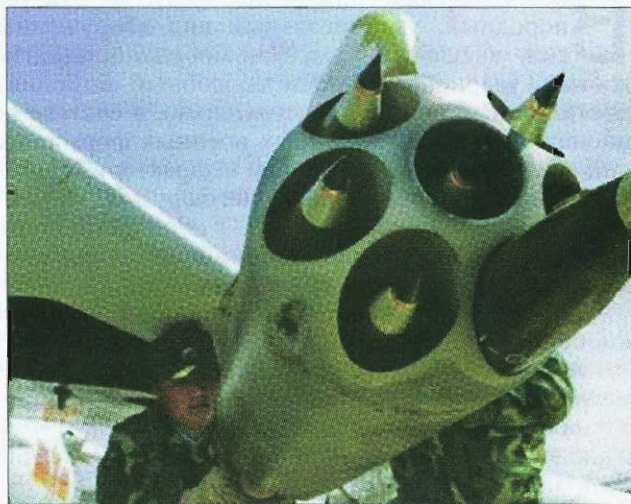
Вооружение штурмовика Q-5 I (вверху – авиационная бомба калибра 250 кг, внизу – блок с зарядкой по восемь НУР калибра 57 мм)
