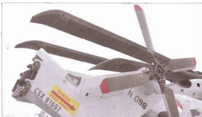
Система складывания лопастей несущего винта и хвостовой балки NH-90 NFH
