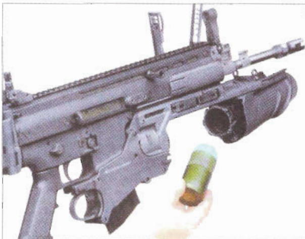
Гранатомет FN40GL/Mk13 имеет поворотную казенную часть
