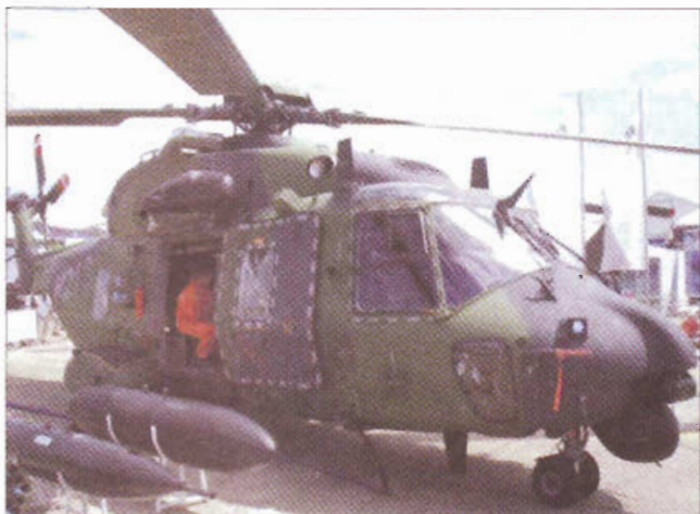
Вертолет NH-90 имеет узкий дверной проем, что не позволяет разместить в нем пулемет
