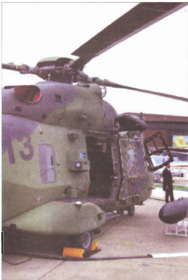
Узкие дверные проемы и недостаточная грузоподъемность лебедки вертолета NH-90 затрудняют высадку десанта
