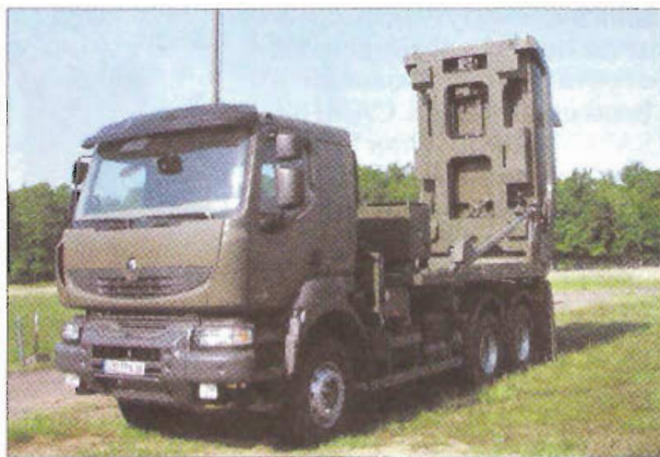
Пусковая установка ЗРК ближнего действия VL MICA на шасси автомобиля «Рено-TRM»
