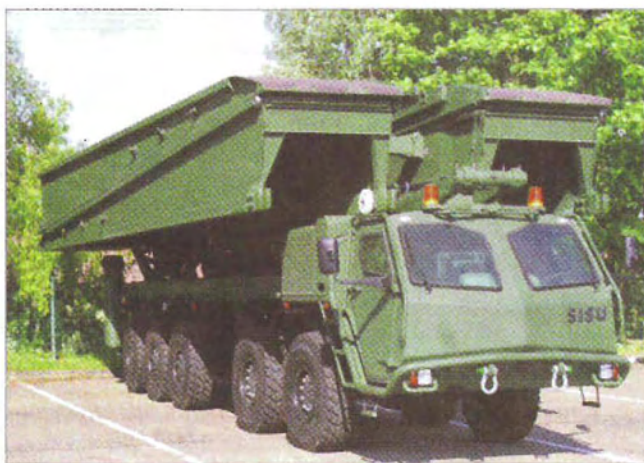
Мостоукладчик с установленными выдвигными секциями моста MLC 85 на шасси финского большегрузного автомобиля «Сису»
