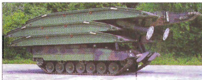
Немецкий механизированный мост PSB-2 «Брагглегер» на гусеничной базе танка «Леопард-2» с установленными секциями моста класса грузоподъемности 85/100
