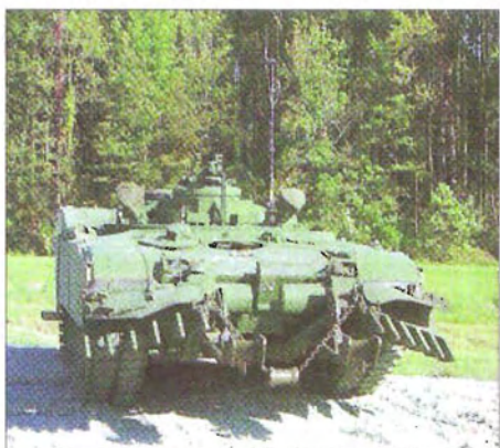
Американская бронированная инженерная машина «Пантера-1» с установленным плужно-ножевым (слева) и катковым (справа) минными тралями
