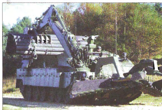
Британская универсальная бронированная инженерная машина «Троян» с установленным плужно-ножевым минным тралом
