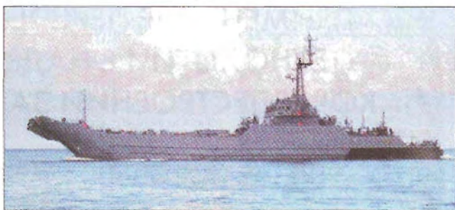
Десантный корабль «Торунь» (бортовой номер 825) проекта 767, так же как и другие ДК, строился для действий в акватории Балтийского моря и в связи с этим имеет ограничения по мореходности и десантовместимости
