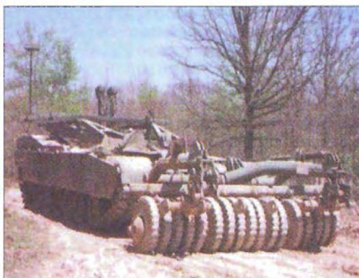
Американская бронированная инженерная машина «Пантера-1» с установленным плужно-ножевым (слева) и катковым (справа) минными тралями
