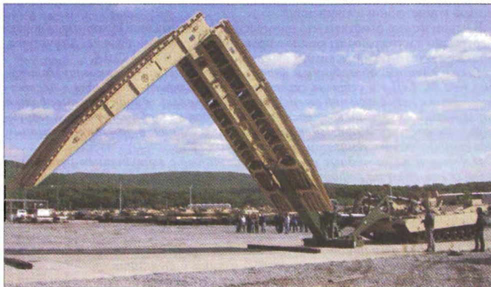
Американский опытный танковый мостокладчик на базе танка M1A2 «Абрамс» с раскладывающимися секциями механизированного моста JAB в рабочем положении
