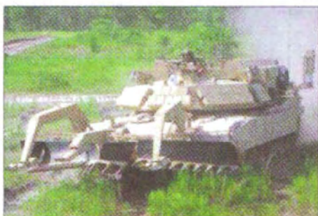
Американская опытная универсальная бронированная инженерная машина «Пантера-2»: в походном (слева) и боевом (справа) положении с пусковыми установками удлиненных зарядов разминирования
