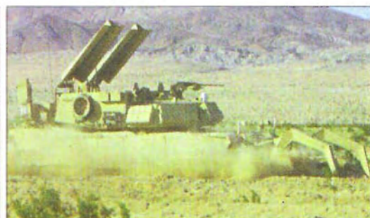
Американская опытная универсальная бронированная инженерная машина «Пантера-2»: в походном (слева) и боевом (справа) положении с пусковыми установками удлиненных зарядов разминирования
