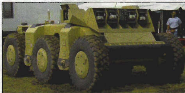
«Крашер», оснащенный лазерным дальномером и видеокамерами
