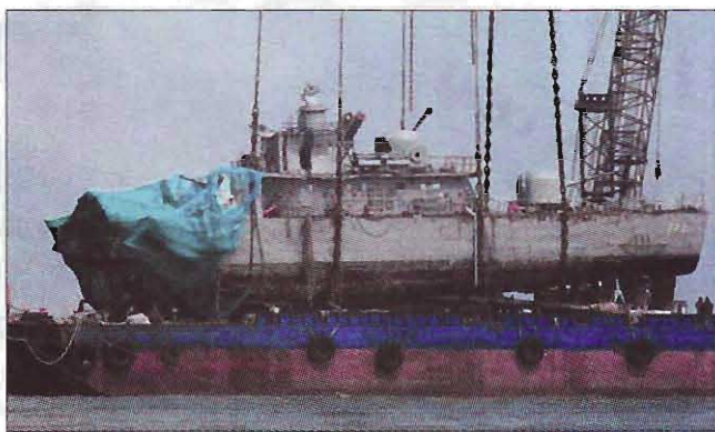
Операция по подъему со дна моря кормовой части корвета «Чхонан»
