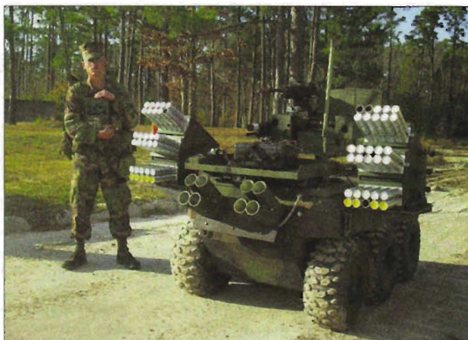
Вариант машины «Гладиатор» с многоствольной гранатометной установкой Metal Storm
