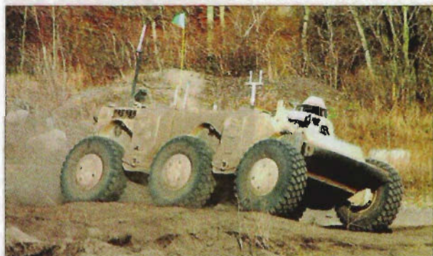
Полевые испытания машины «Крашер» с автономной навигационной системой ANS
