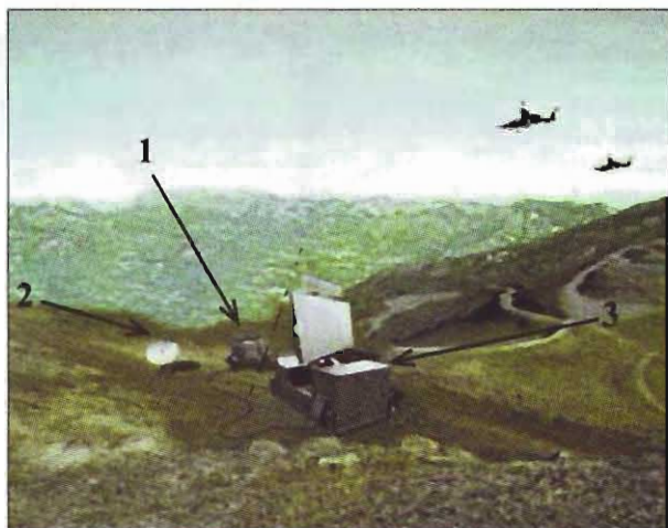
Возможный вариант размещения РЛС GM 400 на позиции: 1 – автономная система энергоснабжения; 2 – терминал спутниковой системы связи; 3 – контейнер с антенной и аппаратурой станции
