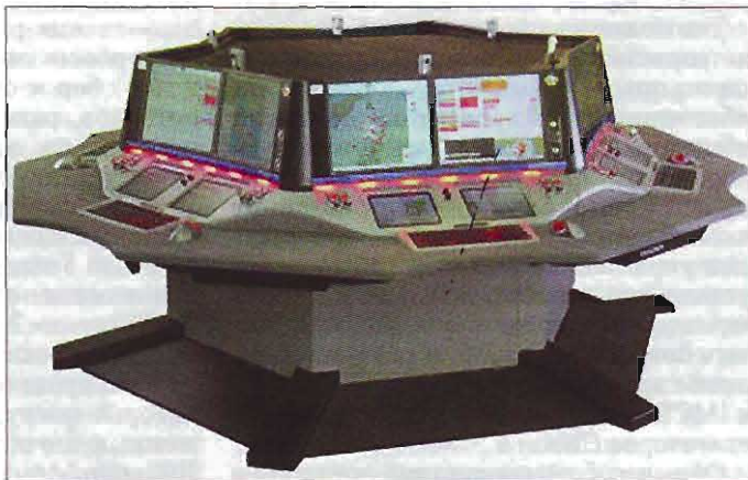
Групповой пульт семейства OMADA, планируемый к установке в БИЦ фрегатов проекта F 125
