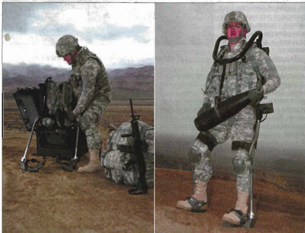
Слева направо: укладка экзоскелета в контейнер для транспортировки и применение экзоскелета при переносе боеприпасов
