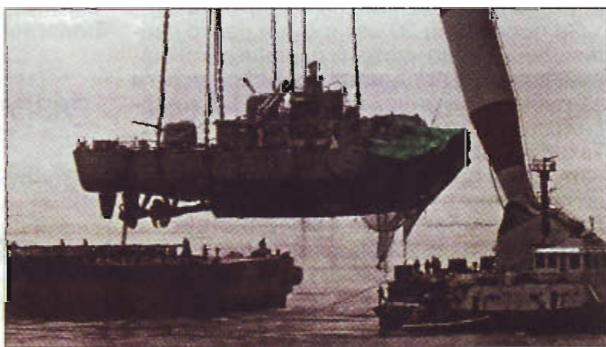
Работы по подъему и транспортировке носовой (вверху) и кормовой (внизу) частей корвета
