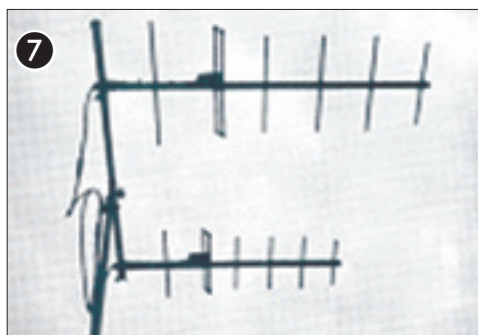
Антенны РРС: 5 – параболическая с облучателем в фокусе; 6 – с плоским рефлектором; 7 – типа «волновой канал»
