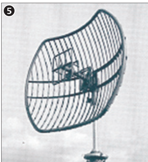
Антенны РРС: 5 – параболическая с облучателем в фокусе; 6 – с плоским рефлектором; 7 – типа «волновой канал»
