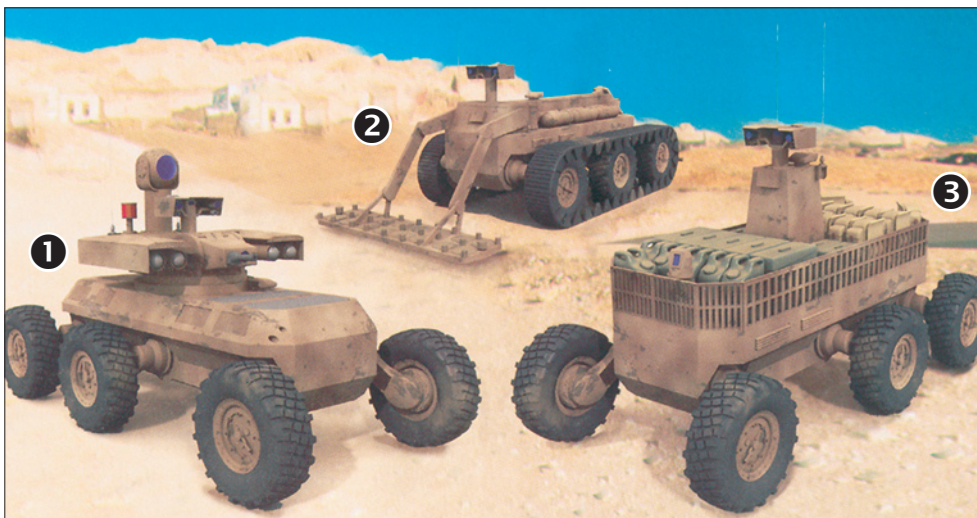
Многоцелевая дистанционно управляемая машина ARV (А): 1 – машина, оснащенная легким вооружением; 2 – машина инженерной разведки; 3 – транспортная машина
