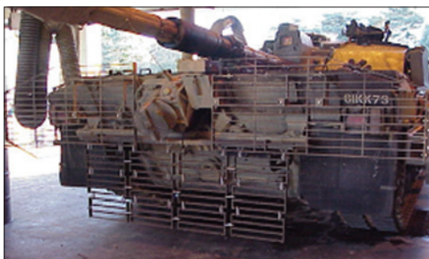
Рис. 2. ОБТ «Челленджер-2» с установленными комплектом броневых решеток на моторно-трансмиссионном отделении, башне и навесной ДЗ по бортам машины
