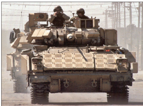
Рис. 3. Американская БМП М2А3 «Брэдли» с установленным на ней комплектом навесной ДЗ
