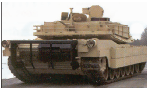
Рис. 1. Основной боевой танк М1А2 «Абрамс» (вид сзади), оборудованный броневой решеткой моторно-трансмиссионного отделения и навесной ДЗ по бортам корпуса
