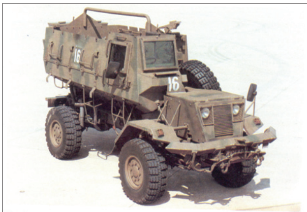
Бронеавтомобиль «Булдог» с усиленной противоминной защитой днища
