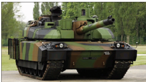
Рис. 4. Французский ОБТ «Леклерк», оборудованный новыми бортовыми экранами и противоккумулятивными решетками моторно-трансмиссионного отделения
