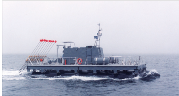
Катер-тральщик с дистанционным управлением типа SAM
