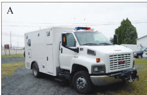
Рис. 3. Мобильная РХБ-лаборатория на шасси грузового фургона «Джи-эм-си»: А – вид снаружи; Б – вид изнутри
