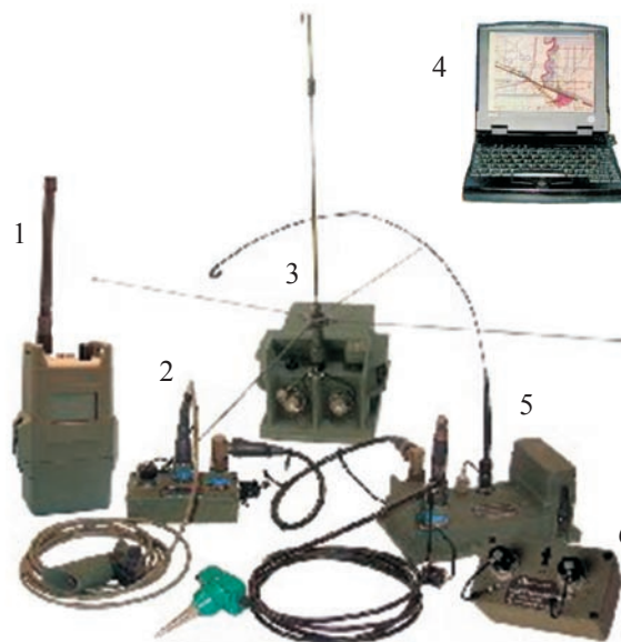
Рис. 5. Основные элементы системы «Рембасс-2»: 1 – устройство индексации и программирования AN/PRQ-16; 2 – инфракрасный РСР МК-2965/GRS; 3 – радиоретранслятор; 4 – станция обработки; 5 – сейсмоакустический РСР МК-2967/GRS 6 – магнитный РСР МК-2966/GRS
