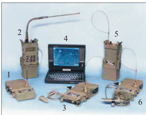
Рис. 4. Основные элементы системы «Усовершенствованный Рембасс»: 1 – магнитный РСР DT-561/GSQ; 2 – устройство индексации и программирования AN/RSQ-7; 3 – сейсмоакустический РСР DT-562/GSQ; 4 – станция обработки; 5 – радиоретранслятор; 6 – инфракрасный РСР DT-565/GSQ
