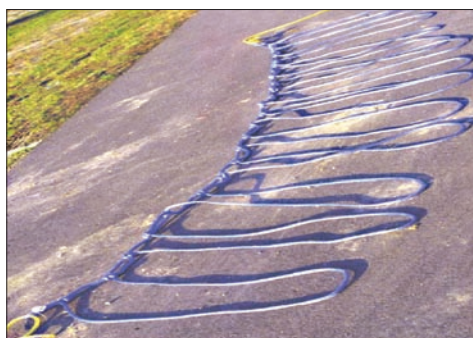
Рис. 6. Устройство РГЕС для остановки малотоннажных судов в развернутом положении
