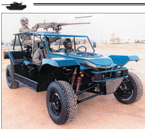
Рис. 1. Специальный ударный автомобиль ALSU (США)
