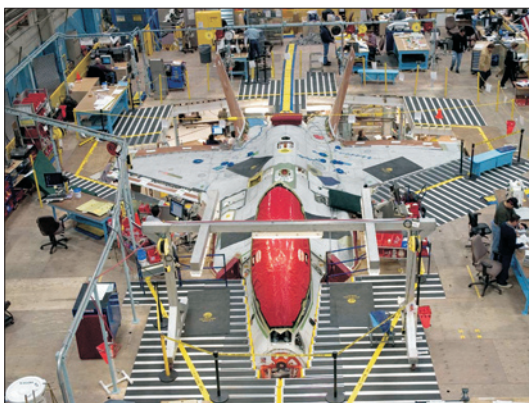
Постройка планера перспективного единого ударного самолета JSF в сборочном цехе компании «Локхид-Мартин»
