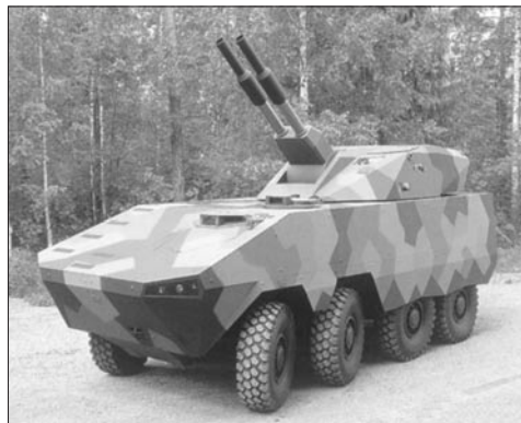
Спаренная 120-мм минометная система AMOS на шасси финского БТР «Патрия»
