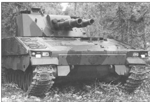
Спаренная 120-мм минометная система AMOS на шасси шведской БМ CV90
