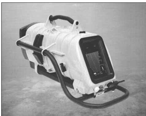
ГАС типа DSE-1 способна обнаружить препятствия под водой на дальности до 200 м
