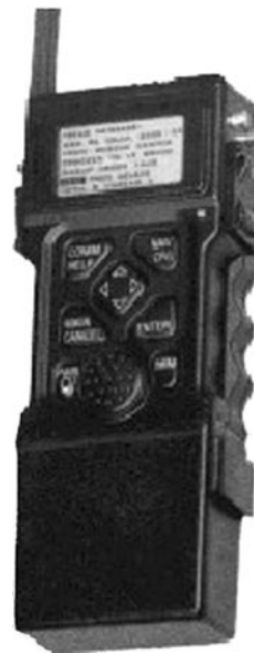
Рис. 9. Перспективная аварийно-спасательная радиостанция AN/PRQ-7
