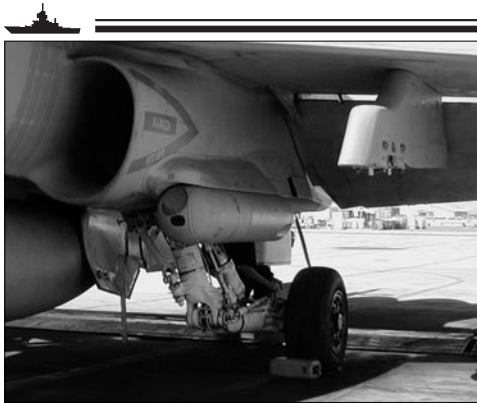
Рис. 4. Размещение контейнера с ПНС AN/ASQ-228 на самолетах F/A-18E/F
