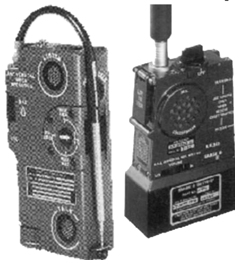
Рис. 1. Аварийно-спасательные радиостанции второго поколения: слева – AN/PRC-90, справа – SARBE-5
