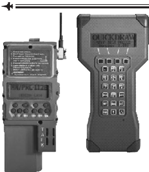
Рис. 3. Аварийно-спасательная радиостанция GPS-112 CSAR (слева) и запросчик Quickdraw
