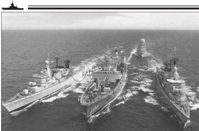
УТРС «Амстердам» пополняет запасы топлива ФР «Блойс ван Треслонг» (F-824) типа «Кортенаэр»
