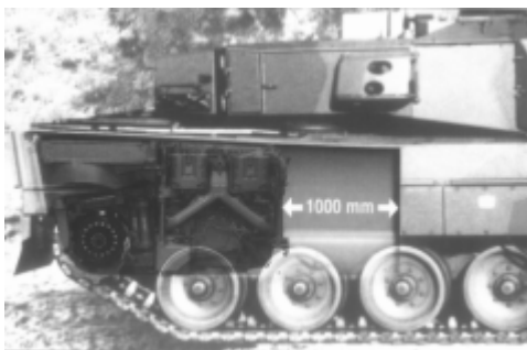
Рис. 2. Расположение силового блока на танке «Леопард-2А6»
