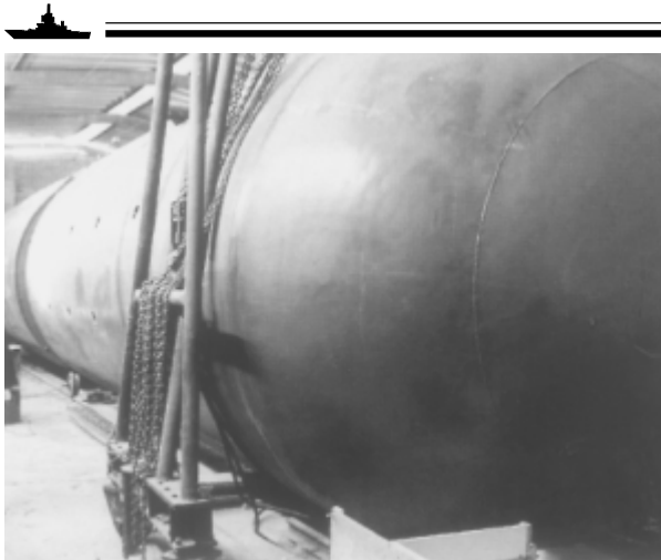
Рис. 2. Одна из обнаруженных в Колумбии строящихся малых подводных лодок (экипаж 12 человек, грузопместимость 150 – 200 т)
