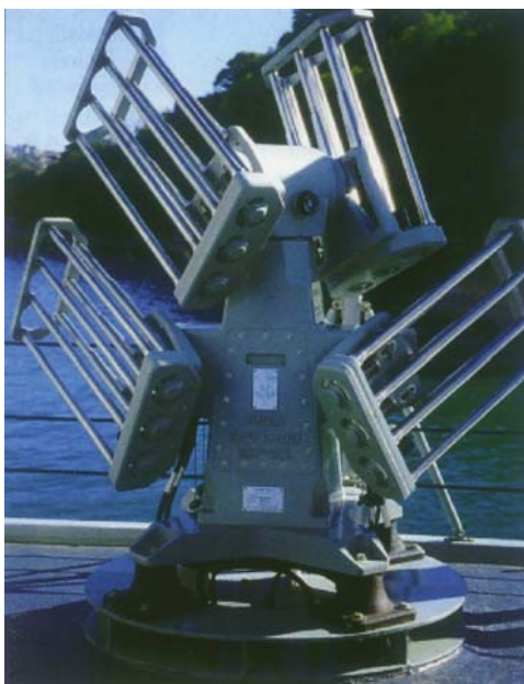
Рис. 7. ПУ «Супер Баррикейд» на ТЩ «Хоксбери» ВМС Австралии
