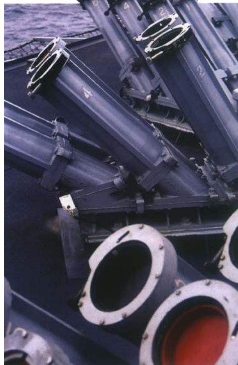
Рис. 1. ПУ DLJ(2) ловушек «Си Гнат» на АВЛ «Илластриес» ВМС Великобритании
