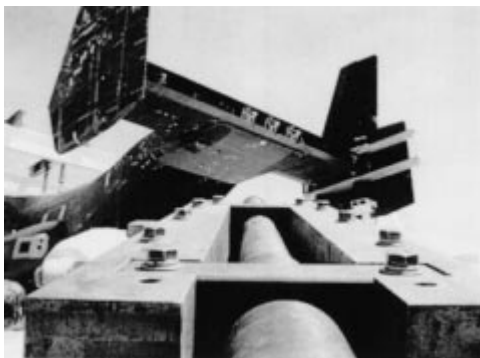
Рис. 2. Баллистические испытания горизонтального стабилизатора самолета V-22
