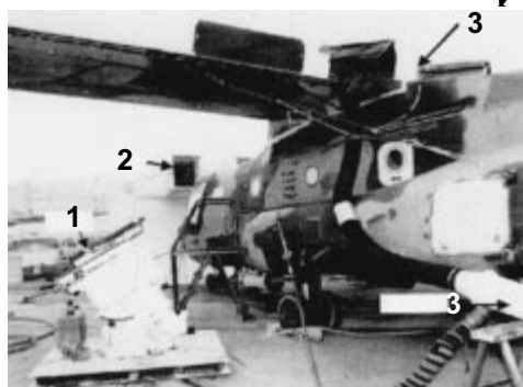
Рис. 3. Баллистические испытания центроплана самолета V-22:
