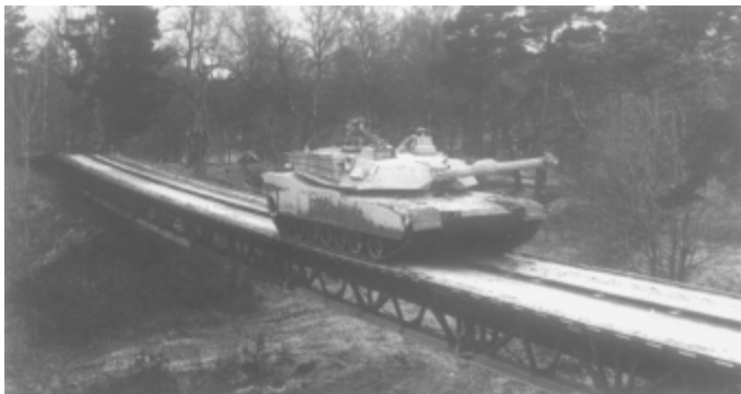
Рис. 1. Танк «Абрамс» движется по мосту HDSB во время испытаний
