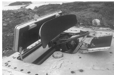
Рис. 2. Выдвижная телескопическая мачта РЛС артустановки «Эрста»
