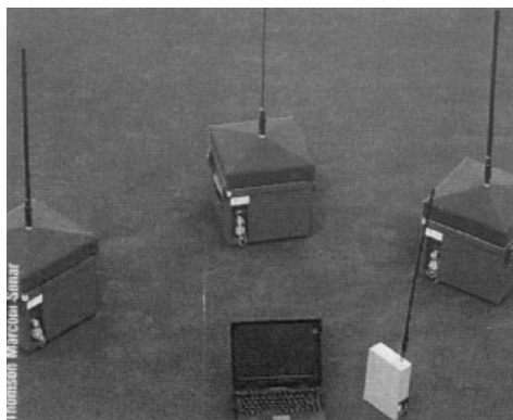
Рис. 7. Французская акустическая система ВАСН обнаружения низколетящих вертолетов
